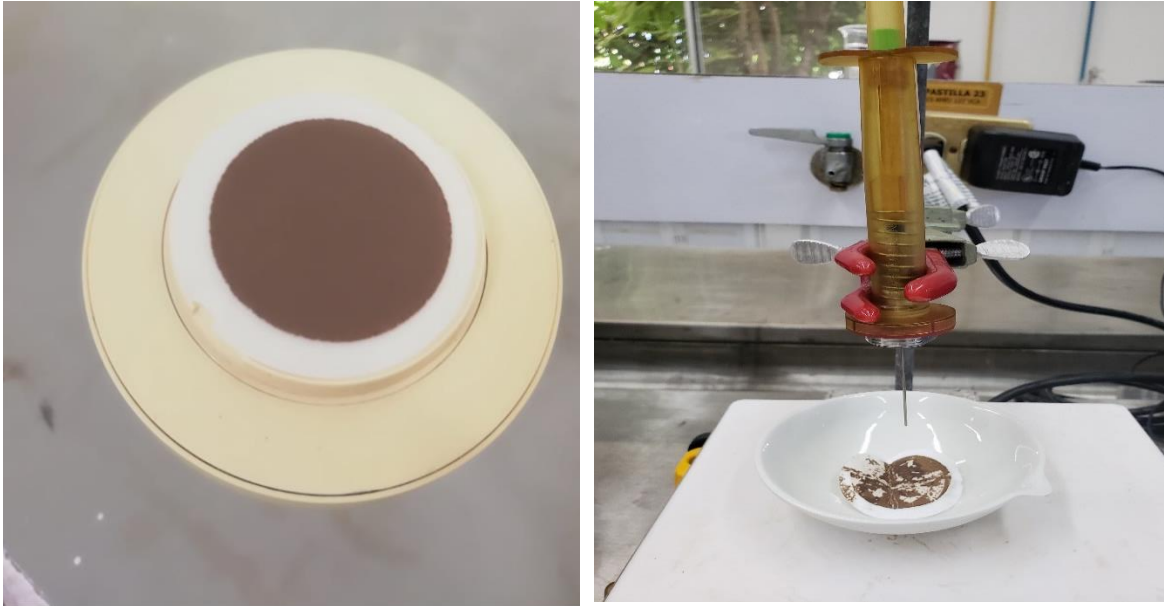
Figura 2.6 y Figura 2.7 Técnica HSPME Aplicada GC MS Sobre Filtrado
