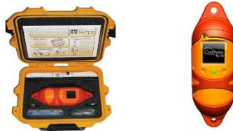
Figura 3-28 Equipo de Medición CASTAWAY CTD
