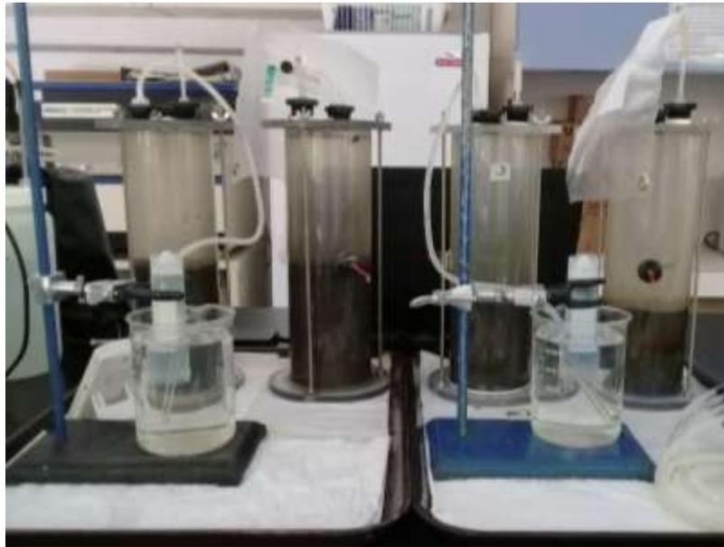
**Ilustración 4-34. Sistema de cámaras simuladoras de reactores anaerobios para captación de gases**
