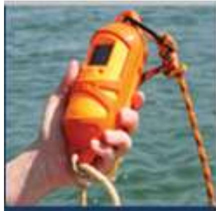
**Ilustración 4-23 CTD utilizado para las mediciones de salinidad, temperatura y profundidad en las bocas de las lagunas costeras y ríos.**
