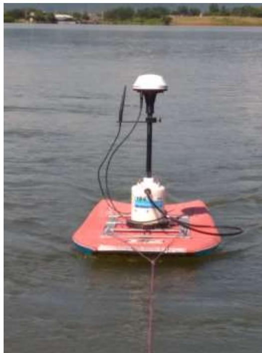
**Ilustración 4-18 Perfilador Doppler M9, montado en una tabla de surf junto con GPS y módulo de energía y comunicación utilizado en la medición.**
