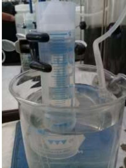
**Ilustración 5-10 Cilindro contenedor de gases de la cámara 3**
