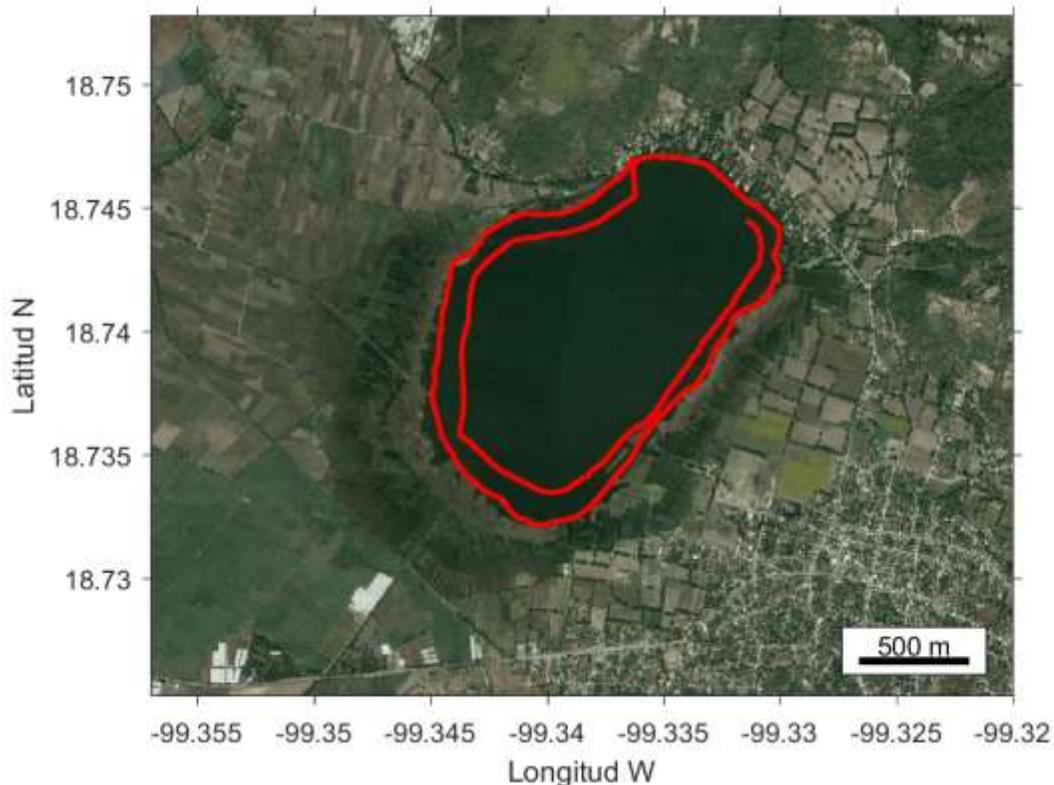
**Ilustración 4-20 Trayectoria de las mediciones con perfilador DopplerM9 en la laguna de Coatetelco.**
