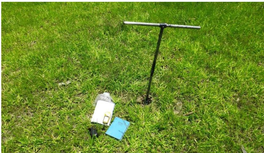
Figura 15. Muestreo de suelos en la cuenca Presa El Gallinero para determinar el factor K.
