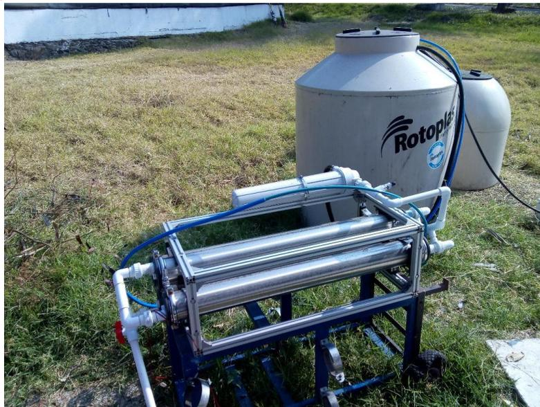
Figura 9. Unidad de Nanofiltración.
