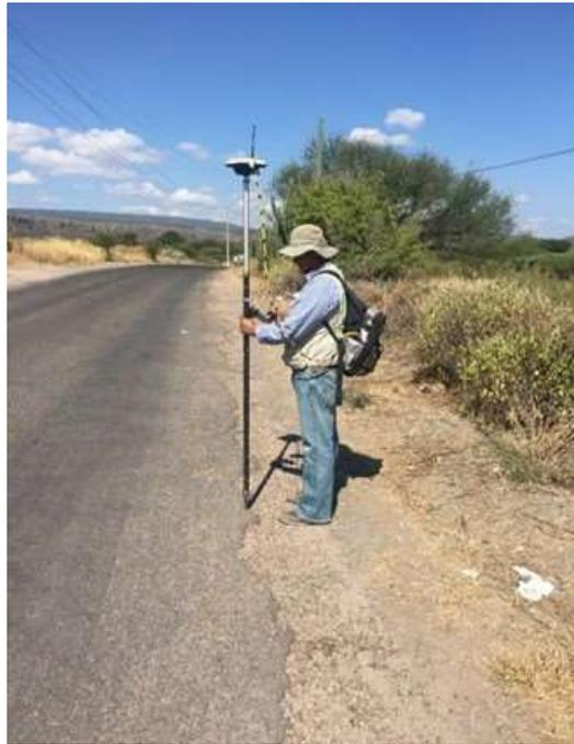
**Figura 7-11. Banco de Nivel 3 está sobre el pavimento representado por un clavo de acero sobre roldana**
