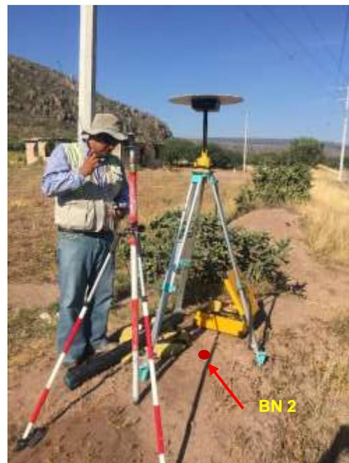
**Figura 7-8. Banco de Nivel 2 (1719.90 msnm), punto inicial del levantamiento**
