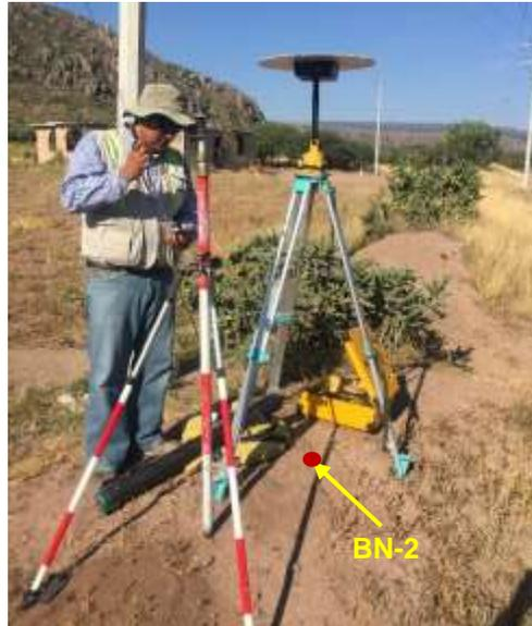
**Figura 7-3. Instalación de equipos estático y móvil en Banco de Nivel 2**
