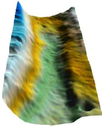
Ilustración 44. Morfología obtenida al final de la serie 28, 5 pruebas. Resistencia a la compresión del material, f'c \approx 45 \text{ kg/cm}^2 . Profundidad de socavación=2.5m. Volumen socavado equivalente en prototipo=12m 3 . Gasto máximo probado 6,010m 3 /s.
