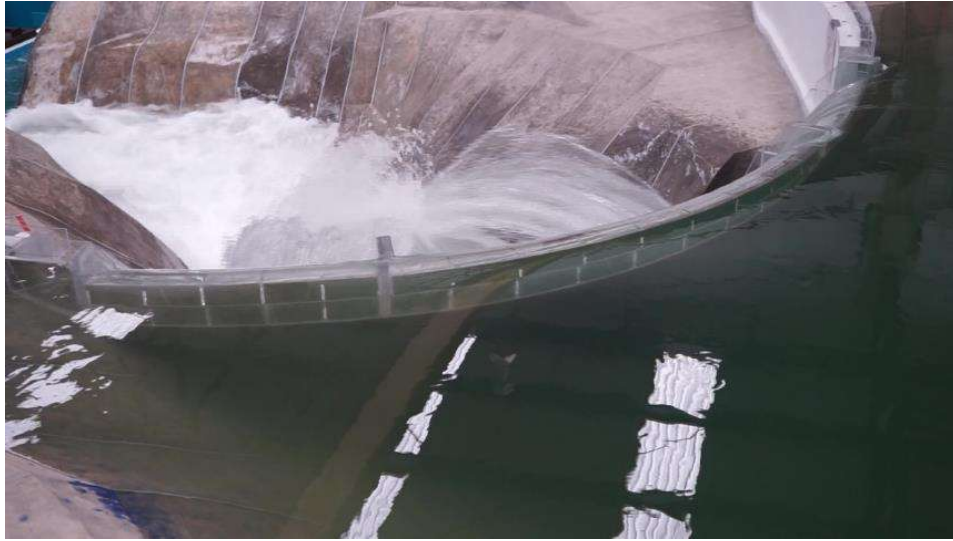
Fotografía. 26. La aproximación del flujo del vaso se aprecia en forma uniforme, sin vorticidad apreciable ni velocidades excesivas. Se observan perturbaciones superficiales pequeñas debidas a la contracción del flujo por la geometría circular del eje de la cresta. Q=6,010\text{m}^3/\text{s}
