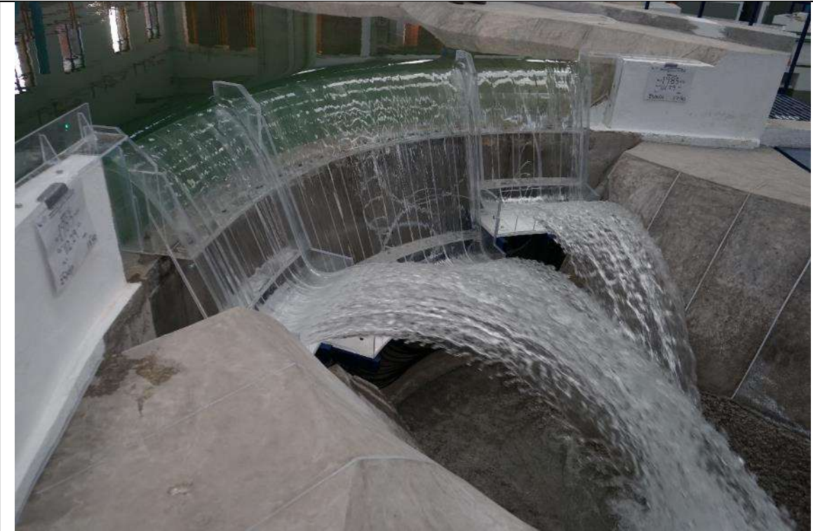
Fotografía. 21. La aproximación del flujo del vaso se aprecia en forma uniforme, sin vorticidad apreciable ni velocidades excesivas. Se observan perturbaciones superficiales pequeñas debidas a la contracción del flujo por la geometría circular del eje de la cresta. Q=3,730\text{m}^3/\text{s}
