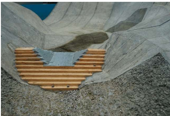
Fotografía. 102. Vista de frente de la ataguía con escotadura de 25.50 m.
