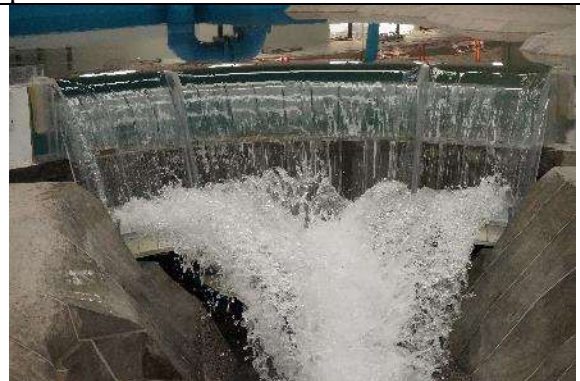
Fotografía. 61. Coque de los chorros en el aire para un gasto asociado a un período de retorno de 1000 años
