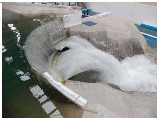
Fotografía. 70. Funcionamiento hidráulico del chorro de despegue para un gasto asociado a un período de retorno de 1000 años
