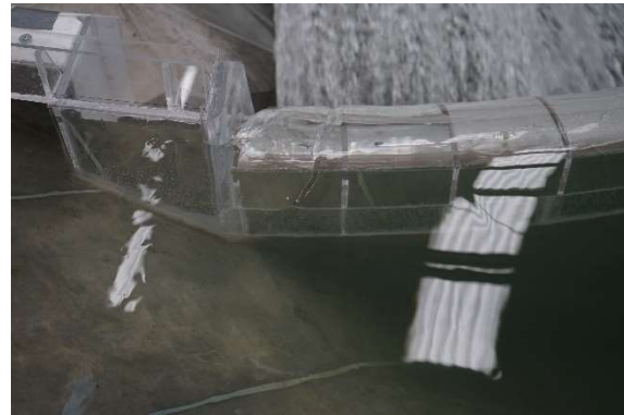
Fotografía 20. Se incrementan las contracciones del flujo en el muro de aproximación de la margen izquierda. Q=4,250\text{m}^3/\text{s}
