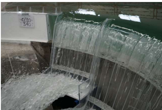
Fotografía 24. Se incrementan las contracciones del flujo en el muro de aproximación de la margen derecha. Q=6,010\text{m}^3/\text{s}
