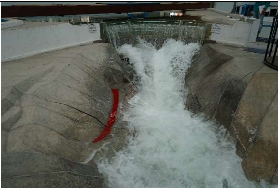
Fotografía. 126. Alcance del chorro para la configuración de la serie 22. El flujo alcanza esporádicamente el camino de acceso y la ventana V1.
