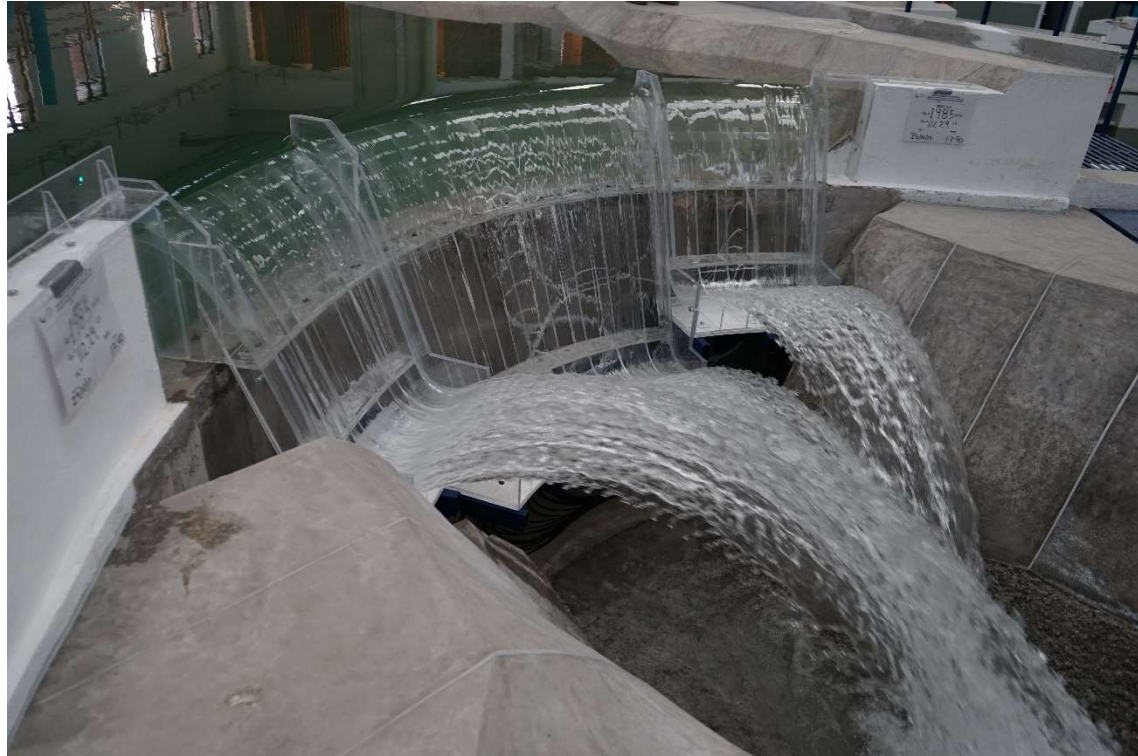
Fotografía 13. La aproximación del flujo del vaso se aprecia en forma uniforme, sin vorticidad apreciable ni velocidades excesivas. Se observan perturbaciones superficiales pequeñas en la rápida debidas a la contracción del flujo por la geometría circular del eje de la cresta. Q=3,730\text{m}^3/\text{s} . No se observa la intrusión de aire en el flujo del vertedor.
