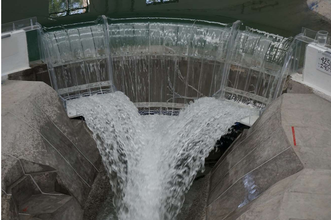
"ESTUDIO EN MODELO FÍSICO DEL FUNCIONAMIENTO HIDRÁULICO DE LA OBRA DE EXCEDENCIA DEL PROYECTO HIDROELÉCTRICO ARENAL ETAPA I-II."
