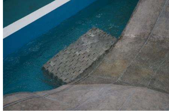
Fotografía. 14. Comportamiento del flujo al final del cauce representado en el modelo. Q=1,215\text{m}^3/\text{s}
