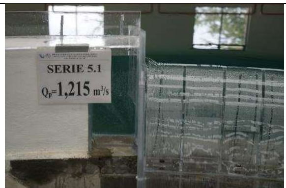
Fotografía. 49. Funcionamiento hidráulico de la pila margen derecha para un gasto asociado a un período de retorno de 2 años
