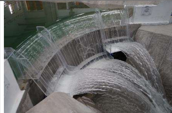
Fotografía. 9. La aproximación del flujo del vaso se aprecia en forma uniforme, sin vorticidad apreciable ni velocidades excesivas. Q=1,215m 3 /s
