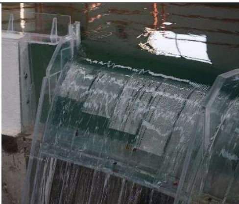
Fotografía. 42. Funcionamiento hidráulico de la pila margen derecha para un gasto asociado a un período de retorno de 50 años
