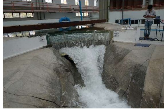
Fotografía. 78. Funcionamiento hidráulico para un gasto de 6010 \text{ m}^3/\text{s} asociado a un periodo de retorno de 1000 años.
