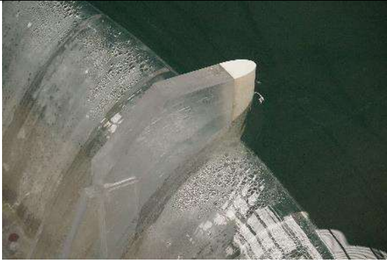
Fotografía. 56. Funcionamiento hidráulico de la pila central P4 para un gasto asociado a un período de retorno de 20 años
