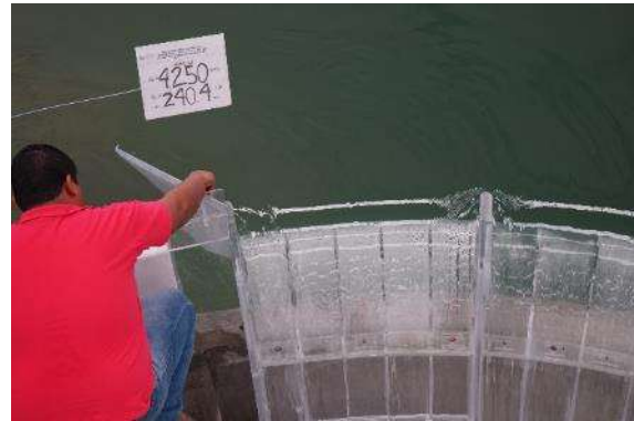
Fotografía. 2. Pruebas provisionales con placas de diversas geometrías, tamaños y posiciones. Margen derecha.
