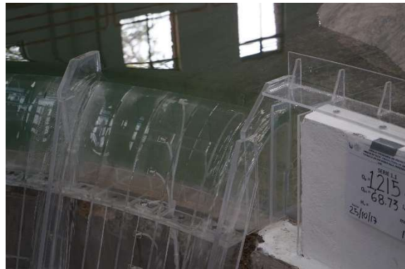
Fotografía 4. Contracciones más pronunciadas del flujo en el muro de aproximación de la margen izquierda. Q=1,215\text{m}^3/\text{s}
