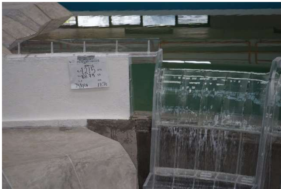
Fotografía 3. Contracciones pronunciadas del flujo en el muro de aproximación de la margen derecha. Q=1,215\text{m}^3/\text{s}
