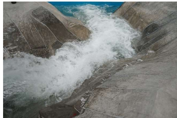
Fotografía 22. Comportamiento del flujo al final del cauce representado en el modelo. Q=4,250\text{m}^3/\text{s} . La perturbación alcanza la sección final del cauce en el modelo.
