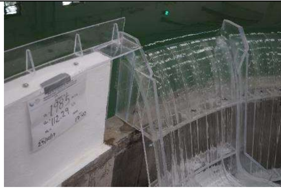
Fotografía. 17. Contracciones más pronunciadas del flujo en el muro de aproximación de la margen derecha. Q=1,985\text{m}^3/\text{s}
