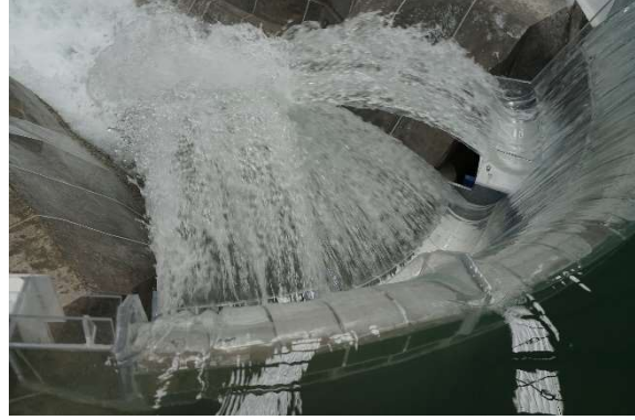
Fotografía. 115. Geometría del chorro para la configuración original. Sin ataguía.
