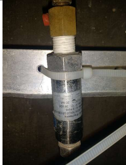
Fotografía. 7. Celda de presión Keller Preciseline.
