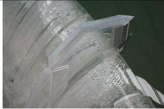
Fotografía. 51. Funcionamiento hidráulico de la pila central P1 para un gasto asociado a un período de retorno de 10 años
