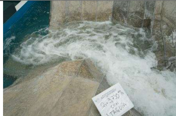
Fotografía. 37. Alcance de los chorros a la cara aguas arriba de la ataguía. Q=3,730\text{m}^3/\text{s}
