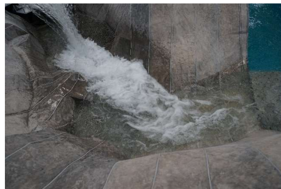
Fotografía 12. Comportamiento del flujo al final del cauce representado en el modelo. Q=1,985\text{m}^3/\text{s} . Disipación de la energía residual en el cauce.
