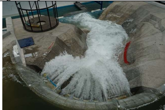
Fotografía. 127. Vista general del flujo en la zona del cuenco y al ingreso del cauce. El flujo confluye hacia el cauce aguas abajo en forma adecuada, sin invadir prácticamente la ladera de la margen derecha aguas debajo de la ataguía
