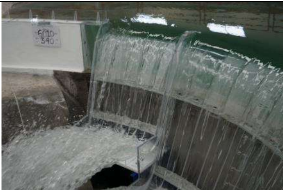
Fotografía. 27. Se incrementan las contracciones del flujo en el muro de aproximación de la margen derecha. Q=6,010\text{m}^3/\text{s}
