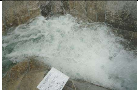
Fotografía. 39. Alcance de los chorros a la cara aguas arriba de la ataguía. Q=6,010\text{m}^3/\text{s}
