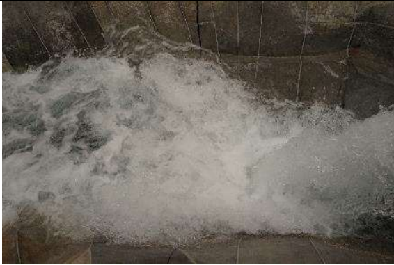
Fotografía. 68. Funcionamiento hidráulico de la caída al cauce del chorro de despegue para un gasto asociado a un período de retorno de 1000 años.
