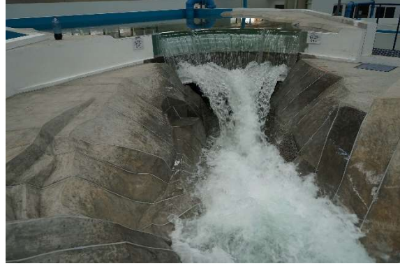
Fotografía. 114. Alcance del chorro para la configuración original. Sin ataguía. El tirante en el canal es barrido hacia aguas abajo.
