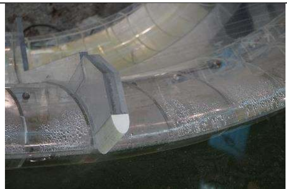
Fotografía. 55. Geometría de Pilas centrales P4 colocada para la serie 6
