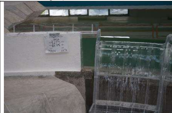
Fotografía. 11. Contracciones más pronunciadas del flujo en el muro de aproximación de la margen derecha. Q=1,215m 3 /s
