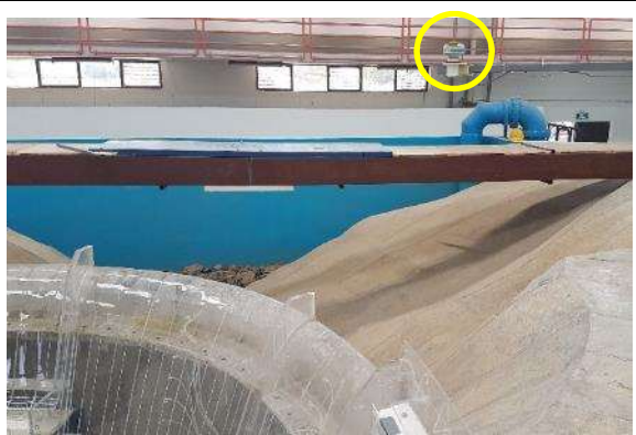
Fotografía. 4. Ubicación del medidor de nivel en el vaso del modelo físico.
