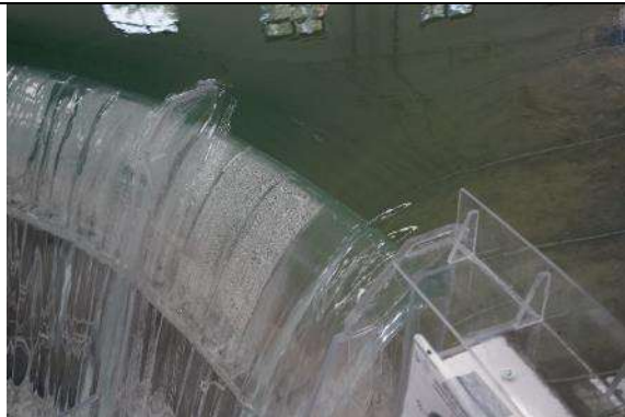
Fotografía. 28. Se incrementan las contracciones del flujo en el muro de aproximación de la margen izquierda. Q=6,010\text{m}^3/\text{s}
