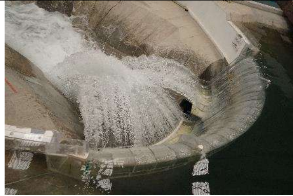
Fotografía. 69. Funcionamiento hidráulico de la caída al cauce del chorro de despegue para un gasto asociado a un período de retorno de 1000 años.
