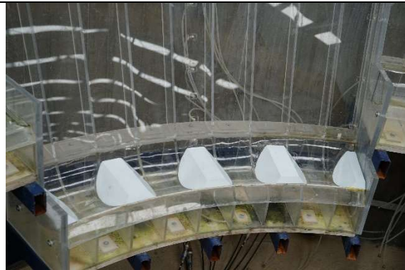
Fotografía. 90. Dados D2 colocados en el deflector del vertedor central.
