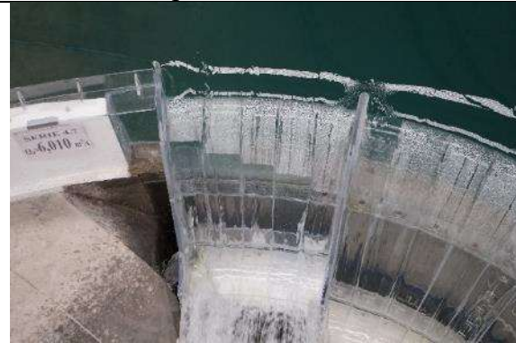
Fotografía. 47. Funcionamiento hidráulico de la pila margen derecha para un gasto asociado a un período de retorno de 1000 años
