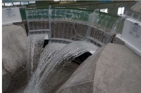
Fotografía 2. Se observan perturbaciones superficiales pequeñas debidas a la contracción del flujo por la geometría circular del eje de la cresta. Q=1,215\text{m}^3/\text{s}
