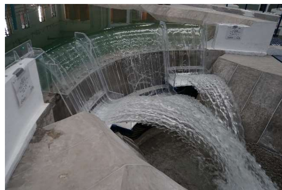
Fotografía 8. Se observan perturbaciones superficiales pequeñas en la rápida debidas a la contracción del flujo por la geometría circular del eje de la cresta. Q=1,985\text{m}^3/\text{s} . Aparece el punto de inyección prácticamente en la sección de tangencia entre la rápida y las cubetas deflectoras.
