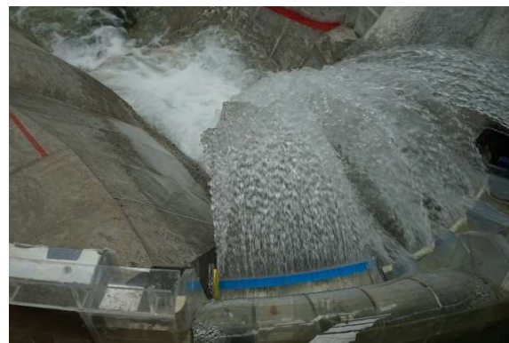
Fotografía. 111. Comportamiento de la caída del chorro en el colchón, para el Q= 6010 \text{ m}^3/\text{s} .
