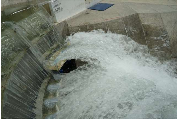
Fotografía. 122. Choque de los chorros en el aire. configuración 22. Con ataguía y escotadura. Se genera mayor amortiguamiento del chorro dentro del estanque.
