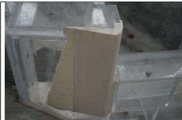
Fotografía. 54. Geometría de Pilas laterales P3 colocada para la serie 6.
