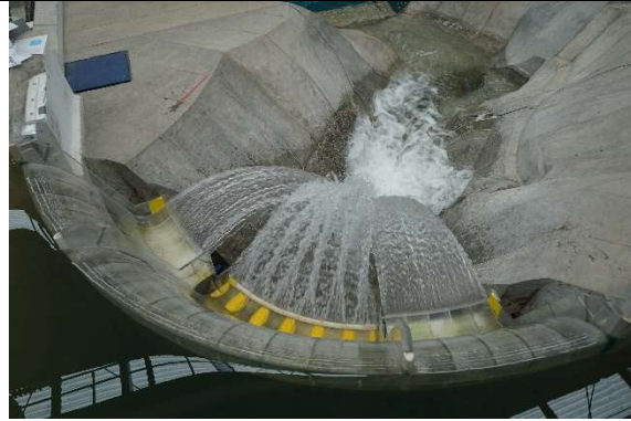
Fotografía. 77. Funcionamiento hidráulico para un gasto de 1,215 \text{ m}^3/\text{s} asociado a un periodo de retorno de 2 años.
