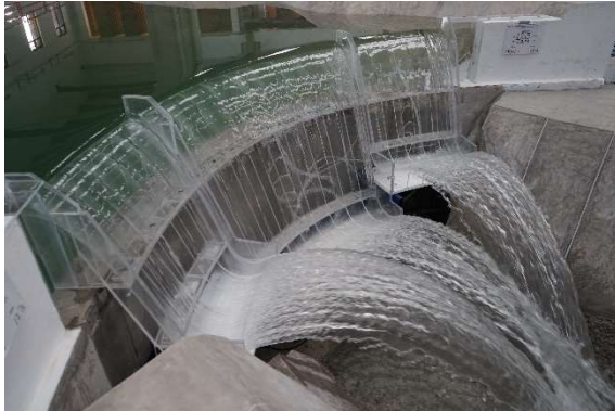
Fotografía 1. La aproximación del flujo del vaso se aprecia en forma uniforme, sin vorticidad apreciable ni velocidades excesivas. Q=1,215\text{m}^3/\text{s}
