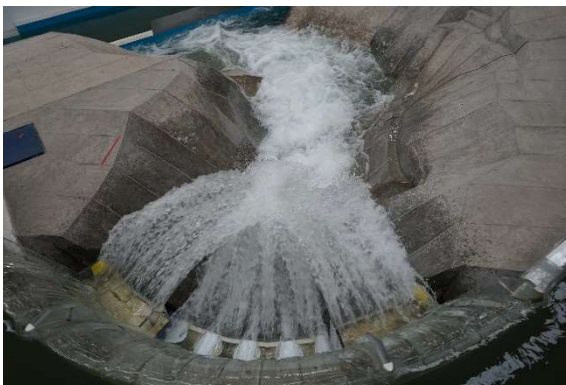
Fotografía. 94. Comportamiento del flujo sin ataguía para el gasto de diseño de 6010 m 3 /s.
