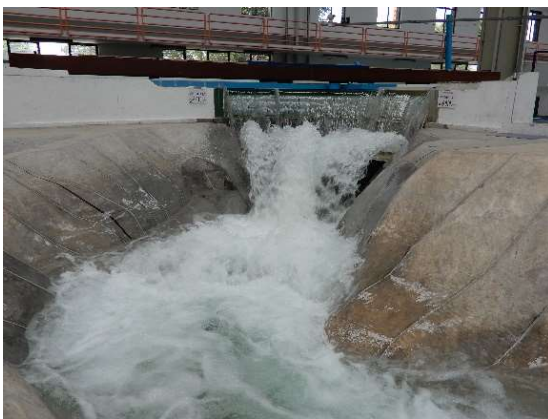
Fotografía. 88. Vista aguas abajo donde se observa cómo funciona la ataguía para un gasto de 6010 \text{ m}^3/\text{s}
