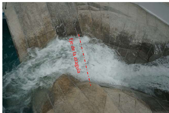
Fotografía 121. Alcance del chorro para la configuración original. Con ataguía. La ventana 1 y su camino de acceso reciben inundaciones periódicas.
