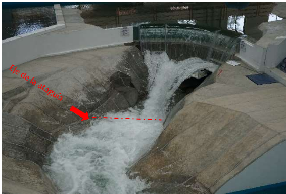
Fotografía 118. Alcance del chorro para la configuración original. Con ataguía. El tirante acumulado es barrido contra la ataguía.
