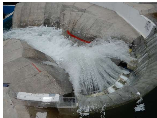
Fotografía. 103. Vista del funcionamiento del vertedor, con ataguía y escotadura de 25.5 m, para un Q= 6010 \text{ m}^3/\text{s} .
