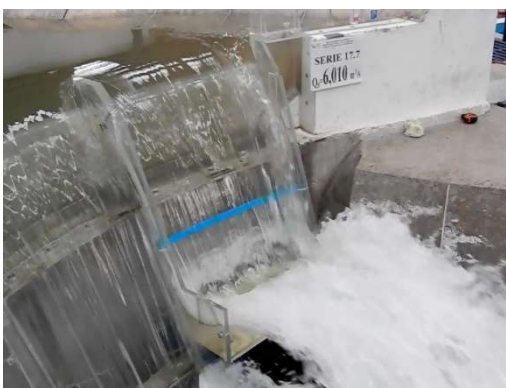
Fotografía. 96. Vista aérea del vertedor para el un Q= 6010 \text{ m}^3/\text{s} .
