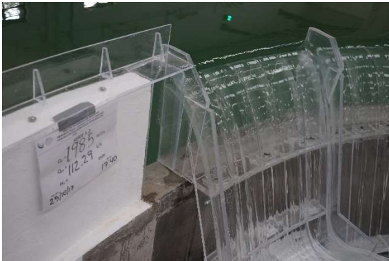
Fotografía 9. Contracciones pronunciadas del flujo en el muro de aproximación de la margen derecha. Q=1,985\text{m}^3/\text{s}
