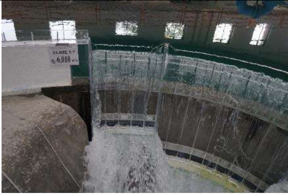
Fotografía. 50. Funcionamiento hidráulico de la pila margen derecha para un gasto asociado a un período de retorno de 1000 años
