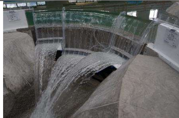
Fotografía. 10. Se observan perturbaciones superficiales pequeñas debidas a la contracción del flujo por la geometría circular del eje de la cresta. Q=1,215m 3 /s
