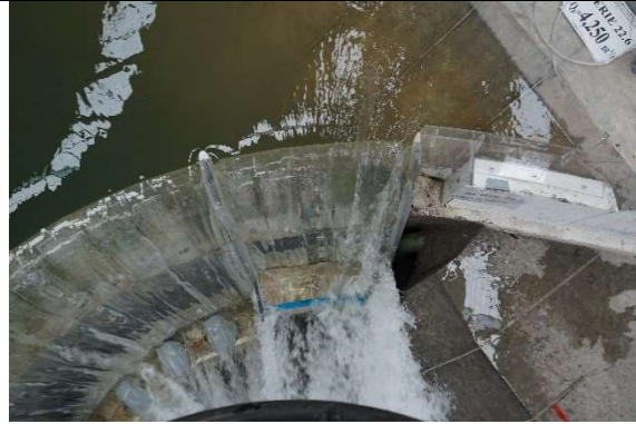
Fotografía. 125. Acceso del flujo al cimacio, pilas centrales y margen derecha. Se observa separación de flujo aceptable, excepto en la margen izquierda donde la perturbación viaja incrementándose hacia aguas abajo.
