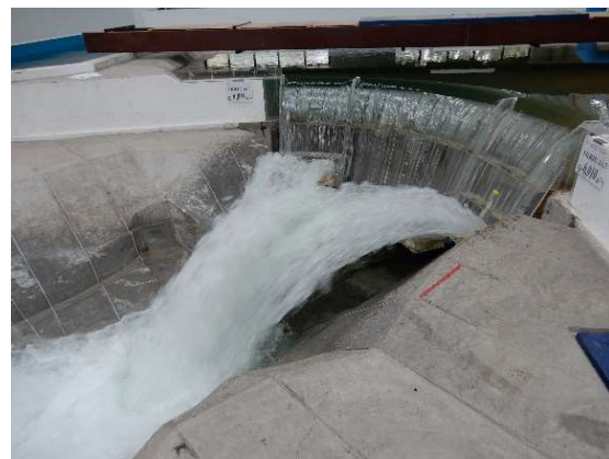
Fotografía. 89. Vista aguas abajo donde se observa el funciona la ataguía.
