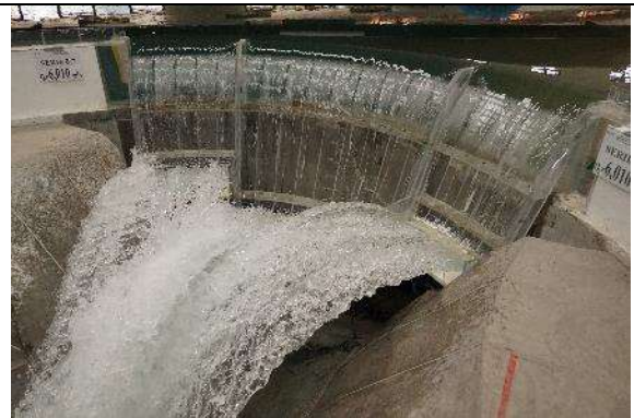
Fotografía. 67. Funcionamiento hidráulico del chorro de despegue para un gasto asociado a un período de retorno de 1000 años.
