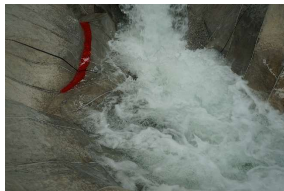
Fotografía. 113. Comportamiento de la caída del chorro en el colchón, para el Q= 6010 \text{ m}^3/\text{s} .
