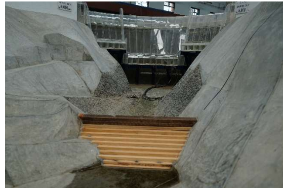
Fotografía. 87. Ataguía sin talud aguas arriba. Vista aguas abajo
