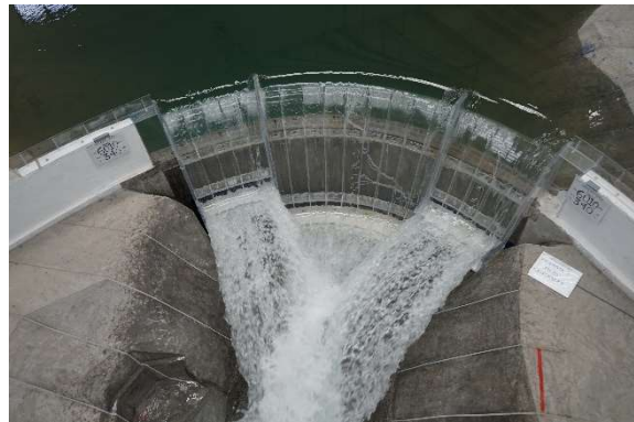
Fotografía 119. Geometría del chorro para la configuración original. Con ataguía.
