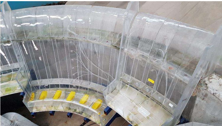
Fotografía. 74. Umbrales trapeciales en el deflector central
