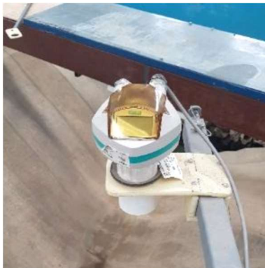
Fotografía. 3. Medidor ultrasónico de nivel de superficie libre del agua.
