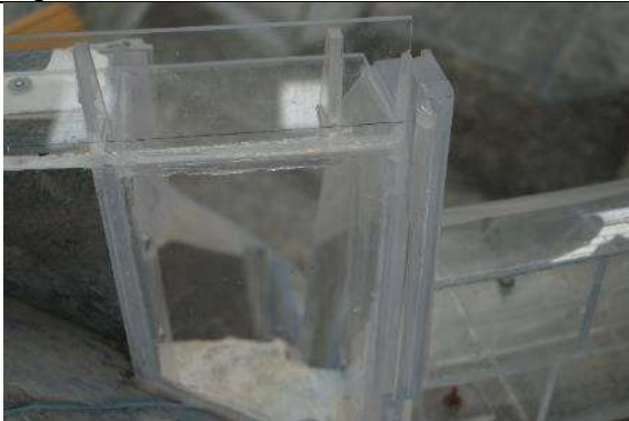
Fotografía. 40. Pila colocada en la margen izquierda para la serie 3.
