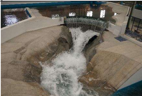
Fotografía. 60. Alcance del agua a la ventana 1 y camino de acceso para un gasto asociado a un período de retorno de 1000 años
