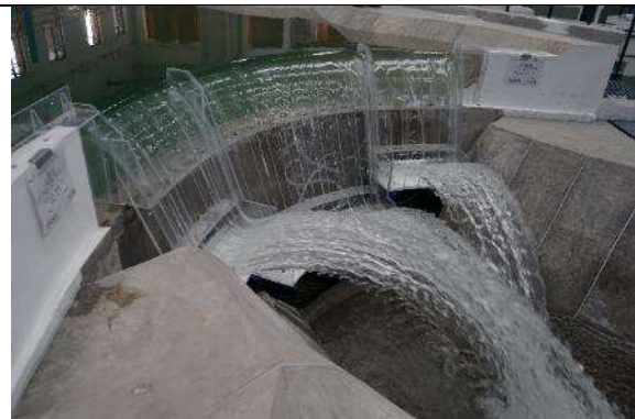
Fotografía. 16. Se observan perturbaciones superficiales pequeñas debidas a la contracción del flujo por la geometría circular del eje de la cresta. Q=1,985\text{m}^3/\text{s}
