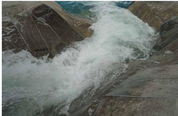
Fotografía 27. Comportamiento del flujo al final del cauce representado en el modelo. Q=6,010\text{m}^3/\text{s} . La perturbación alcanza la sección final del cauce en el modelo.
