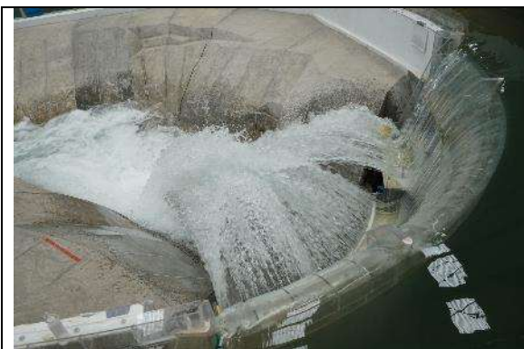
Fotografía. 72. Funcionamiento hidráulico del chorro de despegue para un gasto asociado a un período de retorno de 1000 años
