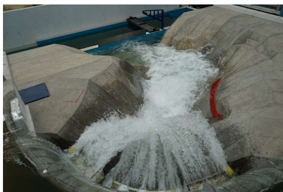
Fotografía. 97. Comportamiento de flujo en la margen derecha del cuenco, para un Q= 6010 \text{ m}^3/\text{s} .
