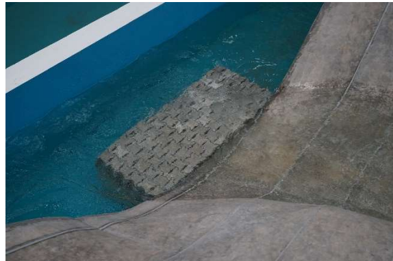
Fotografía 6. Comportamiento del flujo al final del cauce representado en el modelo. Q=1,215\text{m}^3/\text{s}
