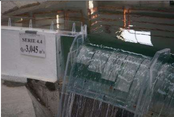
Fotografía. 46. Funcionamiento hidráulico de la pila margen derecha para un gasto asociado a un período de retorno de 20 años
