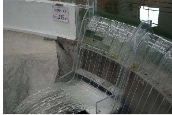
Fotografía. 45. Funcionamiento hidráulico de la pila margen derecha para un gasto asociado a un período de retorno de 2 años
