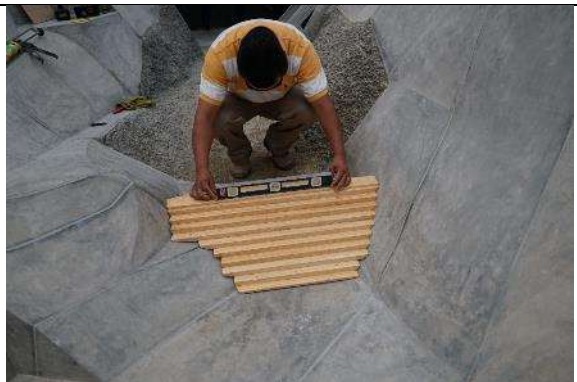
Fotografía. 31. Colocación de la ataguía en el modelo.
