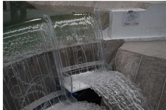
Fotografía 10. Contracciones más pronunciadas del flujo en el muro de aproximación de la margen izquierda. Q=1,985\text{m}^3/\text{s}
