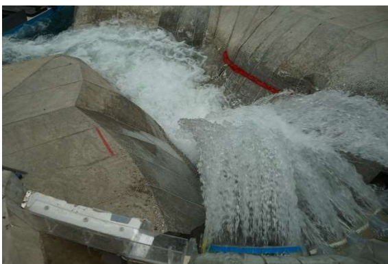
Fotografía. 112. Comportamiento de la caída del chorro en el colchón, para el gasto de diseño.
