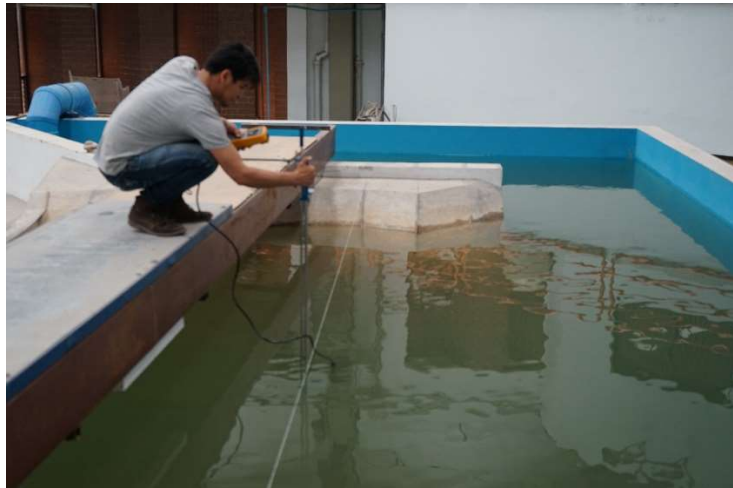
Fotografía. 6. Medición del flujo de aproximación.
