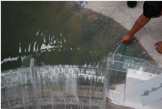
Fotografía. 1. Pruebas provisionales con placas de diversas geometrías, tamaños y posiciones. Margen izquierda.
