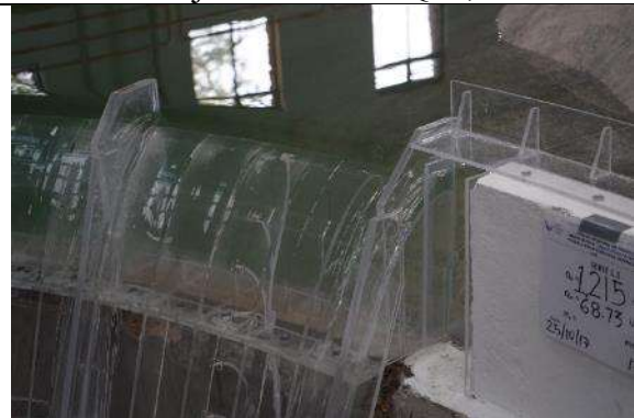
Fotografía. 12. Contracciones más pronunciadas del flujo en el muro de aproximación de la margen izquierda. Q=1,215m 3 /s
