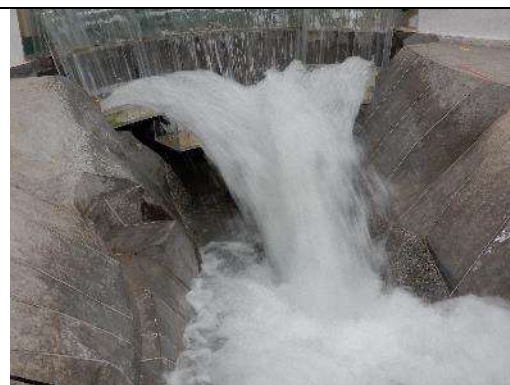
Fotografía. 73. Funcionamiento hidráulico del chorro de despegue para un gasto asociado a un período de retorno de 1000 años.
