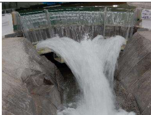
Fotografía. 71. Funcionamiento hidráulico del chorro de despegue para un gasto asociado a un período de retorno de 1000 años.
