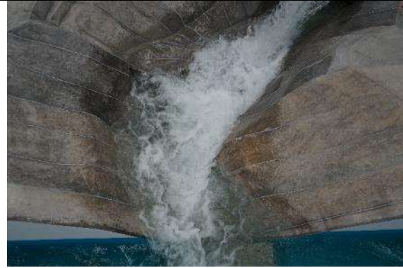
Fotografía. 25. Comportamiento del flujo al final del cauce representado en el modelo. Q=3,730\text{m}^3/\text{s} . La perturbación alcanza la sección final del cauce en el modelo.
