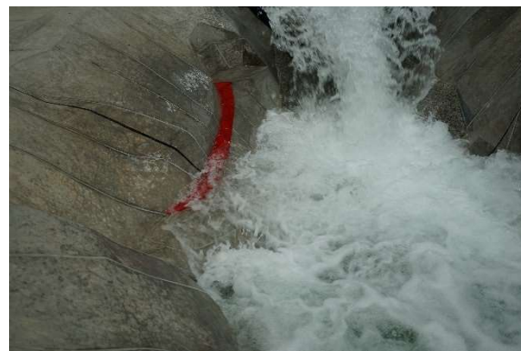
Fotografía. 106. Caída del chorro en el colchón, para un Q= 6010 \text{ m}^3/\text{s} .
