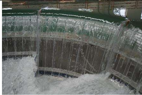
Fotografía. 53. Funcionamiento hidráulico de las pilas centrales P1 y P2 para el gasto de diseño asociado a un período de retorno de 1000 años
