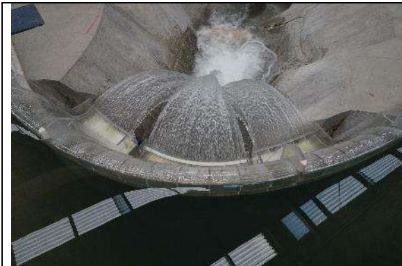
Fotografía. 66. Funcionamiento hidráulico del chorro de despegue para un gasto asociado a un período de retorno de 1000 años
