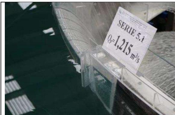
Fotografía. 48. Pila colocada en la margen derecha para la serie 5.
