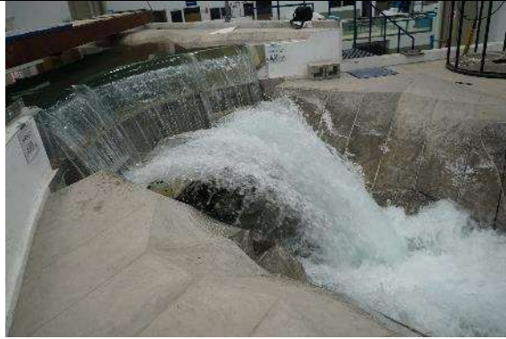
Fotografía. 63. Funcionamiento hidráulico del chorro de despegue para un gasto asociado a un período de retorno de 1000 años.
