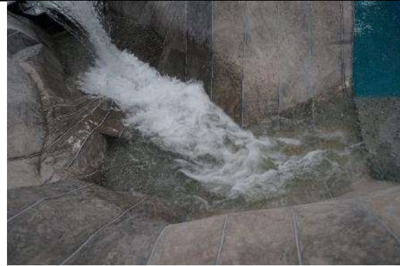
Fotografía. 20. Comportamiento del flujo al final del cauce representado en el modelo. Q=1,985\text{m}^3/\text{s} . Se simula la disipación de energía en el cauce.
