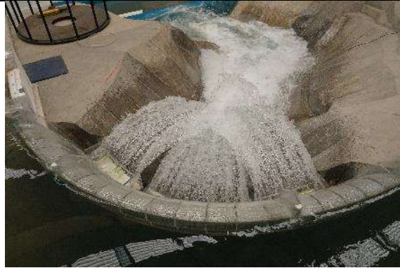
Fotografía. 65. Funcionamiento hidráulico de la caída al cauce del chorro de despegue para un gasto asociado a un período de retorno de 1000 años.
