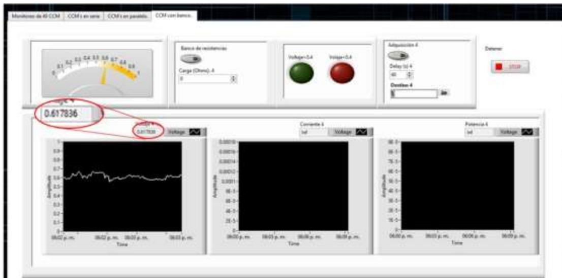
**Figura 41.** Interfaz funcionando en la adquisición de voltaje de una sola CCM
