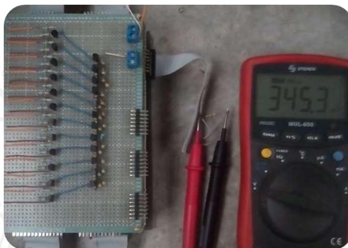
**Figura 73.** Medición de voltaje en una resistencia comercial de  $39K\Omega$  en lugar de la resistencia de  $39K\Omega$  asignada por el banco de resistencias
