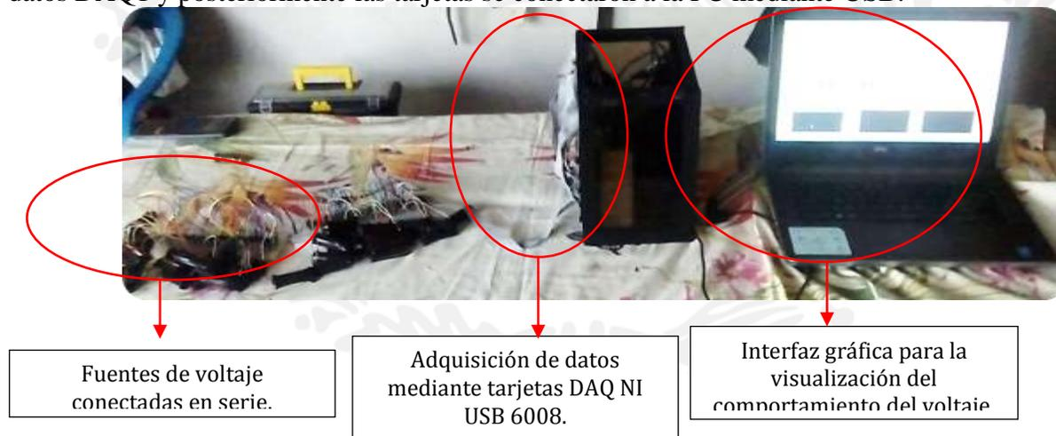
**Figura 32.** Conexión del sistema para pruebas con 40 fuentes de voltaje de 0.58V conectadas en serie
