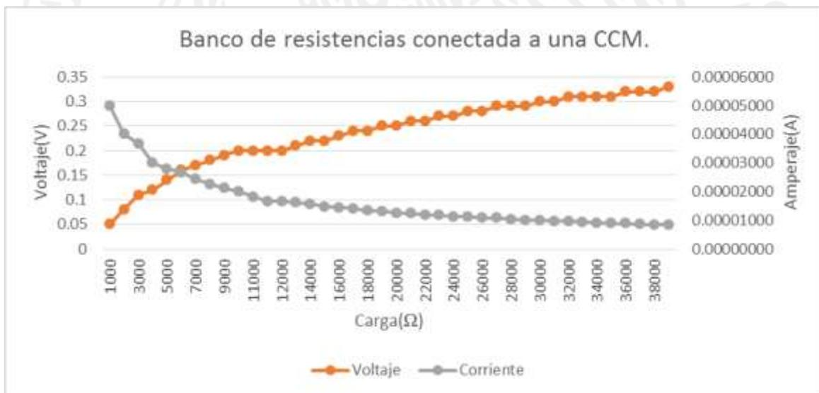
**Figura 68.** Comportamiento del voltaje y corriente en una CCM a distintas cargas programadas en el banco de resistencias
