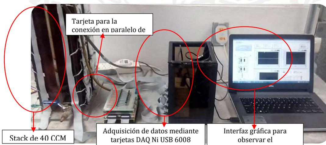
**Figura 48.** Conexión del sistema para la prueba de este con las 40 CCM en paralelo
