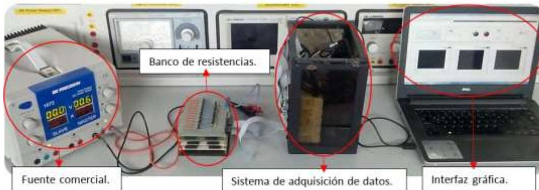
**Figura 54.** Conexión del sistema para la realización de pruebas del banco de resistencias con fuente comercial
