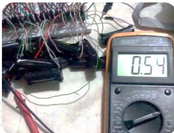
**Figura 39.** Medición de voltaje con multímetro de la conexión en paralelo de 40 fuentes de voltaje de 0.58V
