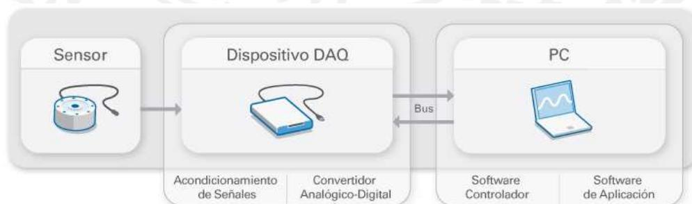
**Figura 1.** Sistema de adquisición de datos DAQ
