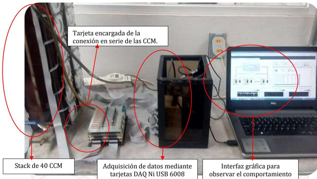
**Figura 44.** Conexión del sistema para la prueba de las 40 CCM conectadas en serie
