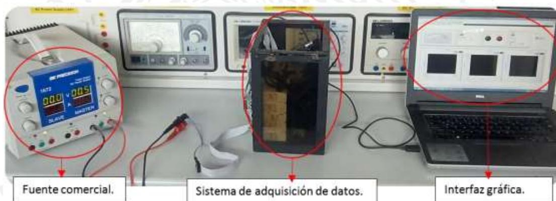
**Figura 27.** Diagrama de conexión del sistema de monitoreo en tiempo real
