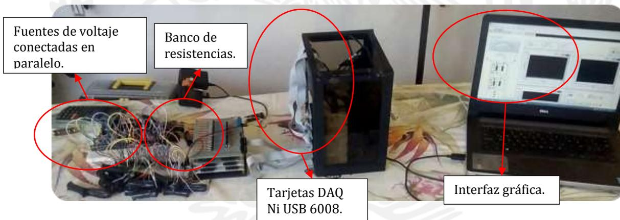
**Figura 62.** Sistema conectado para la realización de la prueba del banco de resistencia con la conexión en paralelo de 40 fuentes de voltaje de 0.58V
