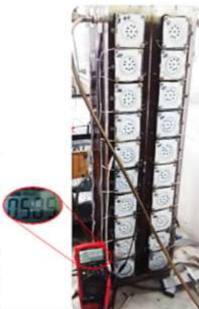
**Figura 02.** Medición de voltaje con multímetro en la CCM correspondiente a esta prueba
