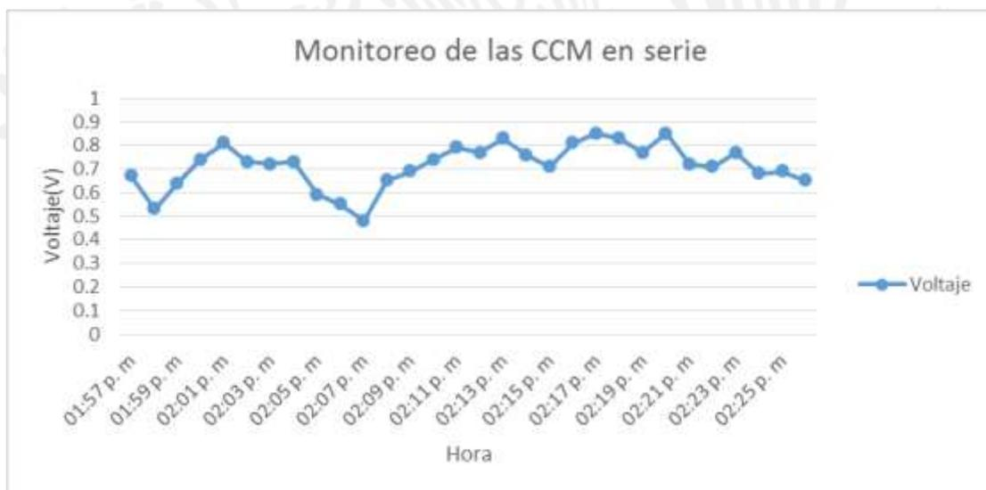
**Figura 06.** Comportamiento del voltaje resultante de la conexión en serie de 40 CCM
