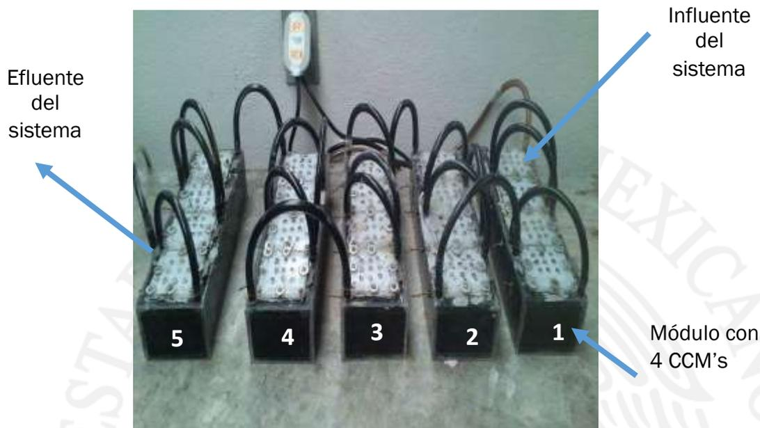
Figura 5. Sistema de Multicelda 1 conformado por 20 CCM's
