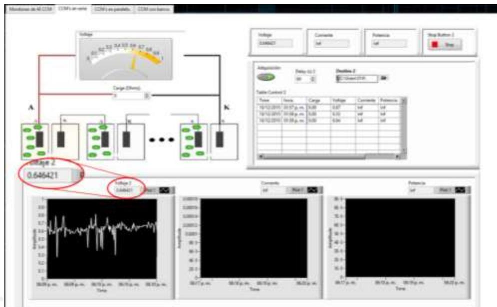
**Figura 05.** Interfaz funcionando para la conexión en serie de las 40 CCM
