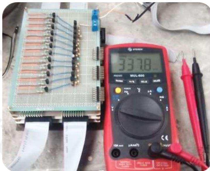
**Figura 51.** Medición con una multímetro del voltaje resultante de la conexión en paralelo de las 40 CCM
