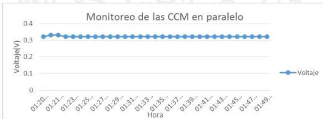
**Figura 50.** Comportamiento del voltaje resultante de la conexión en paralelo de las 40 CCM
