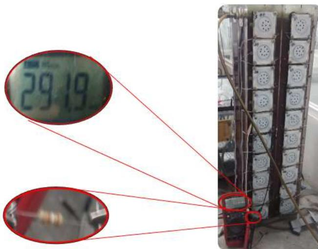
**Figura 69.** Lectura de voltaje en una resistencia comercial de  $39\text{K}\Omega$  en lugar de la resistencia de  $39\text{K}\Omega$  programada en el banco de resistencias
