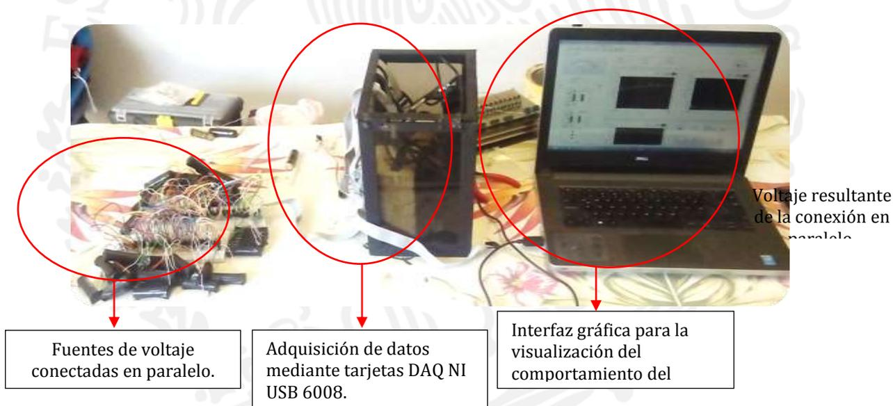
**Figura 36.** Conexión del sistema para la prueba de 40 fuentes de 0.58V conectadas en paralelo
