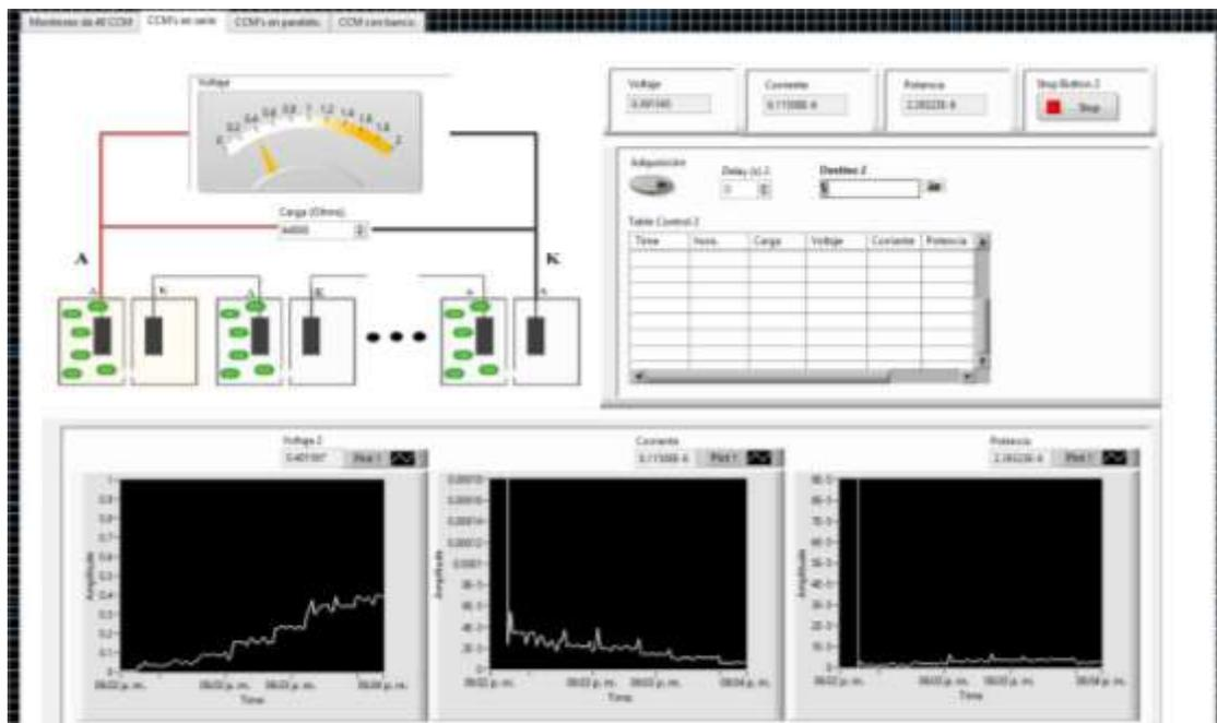
Figura 71. Interfaz funcionando en las 40 CCM conectadas en serie utilizando banco de resistencias
