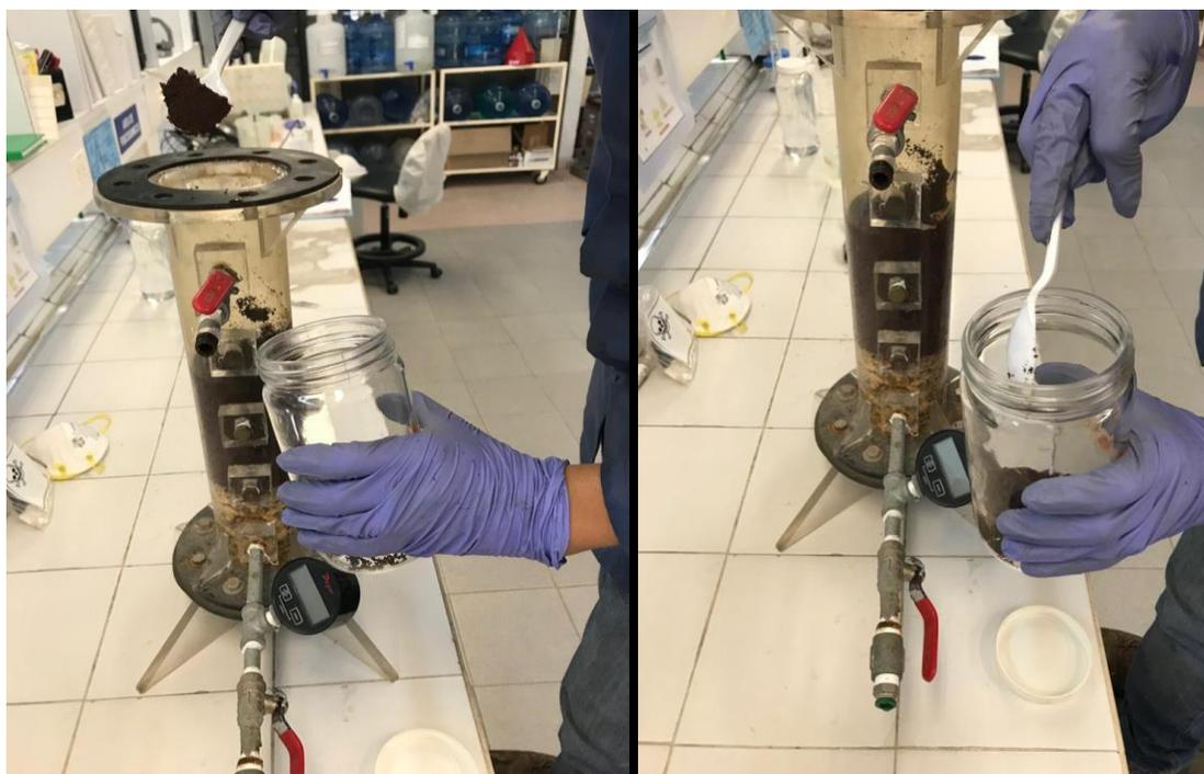
**Ilustración 10 Toma de muestra de material adsorbente para su análisis CRIT.**
