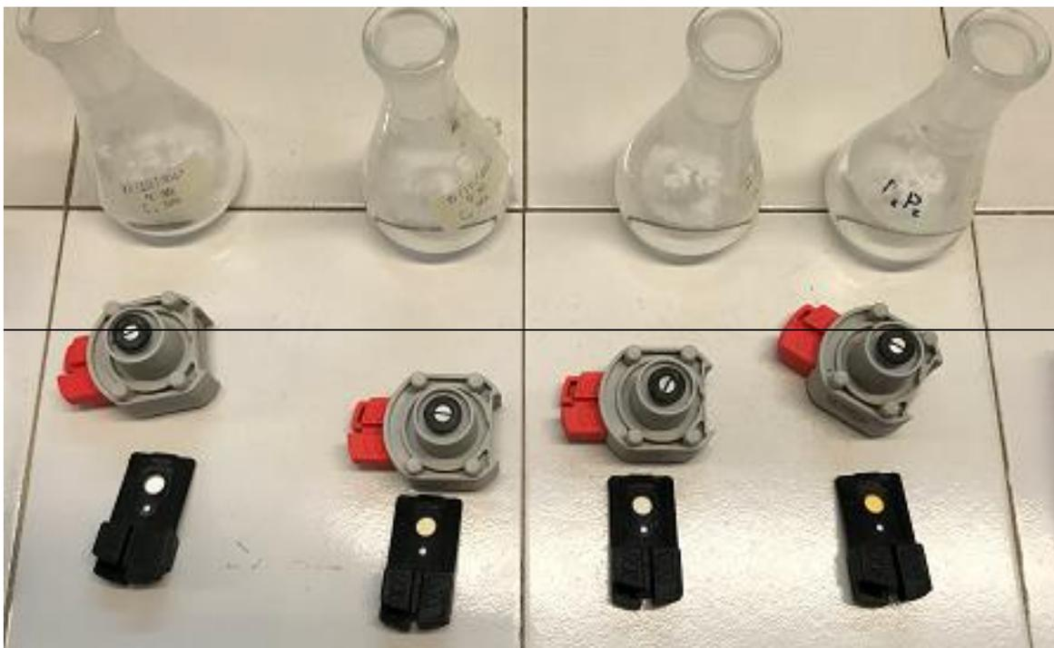
Ilustración 4. Aspecto de la determinación de arsénico empleando el método del Arsenator<sup>®</sup>
