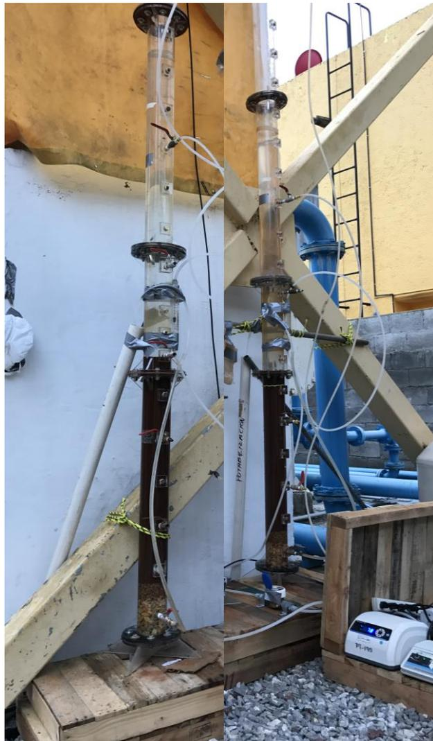
Ilustración 2. Vista de los filtros C1 y C2 instalados cerca de la fuente de abastecimiento PT.
