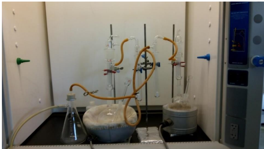
Figura A-5 Montaje para realizar la determinación de Cianuros
