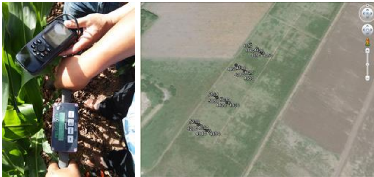
Figura 8.7 Monitoreo de la humedad del suelo con TDR y uso de sistemas de información geográfica como herramienta de apoyo para seguimiento del riego en parcelas
