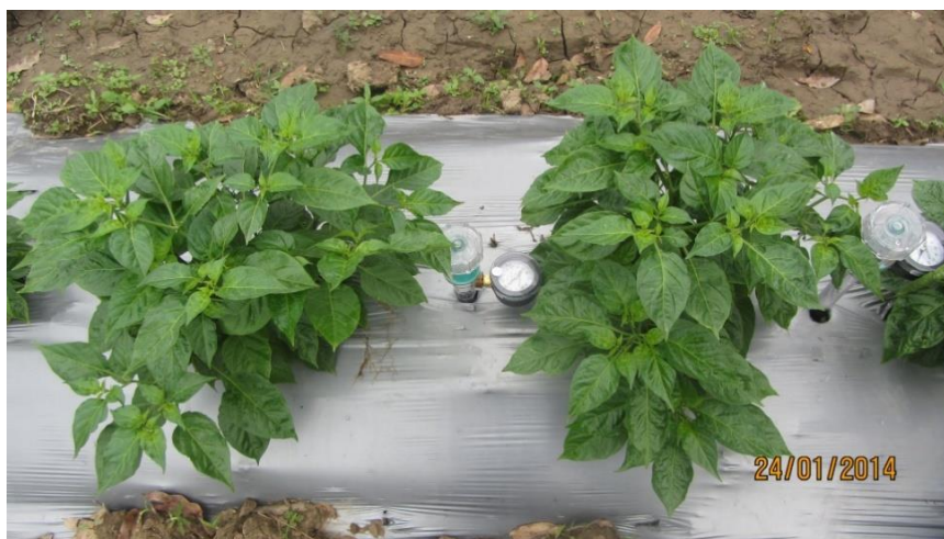
Figura 9.8 Tensiómetros instalados a 15 y 30 cm de profundidad en el cultivo de chile habanero
