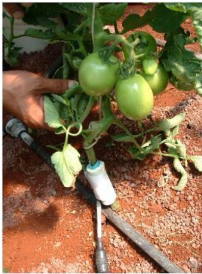
Figura 4.23 Sensor de flujo de savia para estimar la evapotranspiración del cultivo
