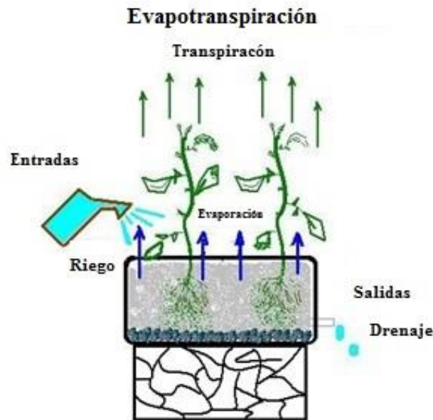
Figura 4.18 Esquema del lisímetro de balance
