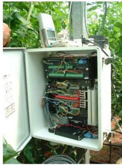
Figura 4.23 Sensor de flujo de savia para estimar la evapotranspiración del cultivo
