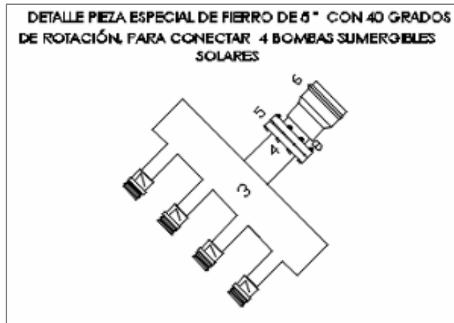
Figura 3.24 Detalle pieza especial de hierro para conectar bombas sumergibles solares
