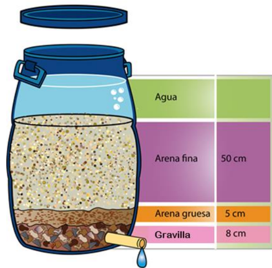
Figura 2.11 Esquema de un filtro casero de grava y arena
