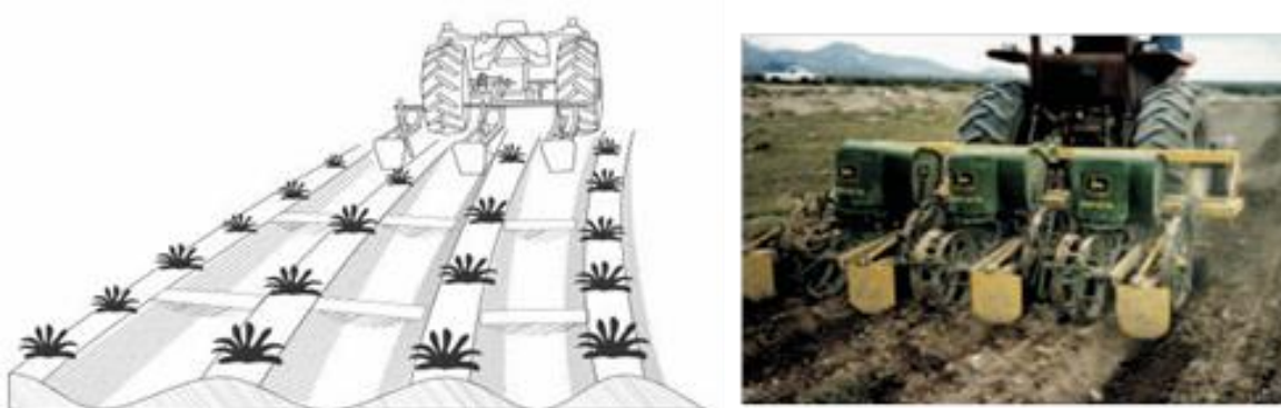
Figura 2.38 Esquema de la formación de bordos en un surco con pileteadora ensamblada a una cultivadora agrícola (Flores et al. , 2014 y SAGARPA – Colegio de Postgraduados, s.f.)
