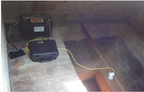
Figura 4.16 Equipo de medición que se instaló en aforador de la microcuenca Malacate
