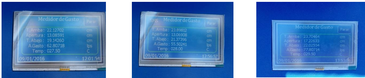
Figura 4.43 Información obtenida en campo a través de los equipos de medición de caudal
