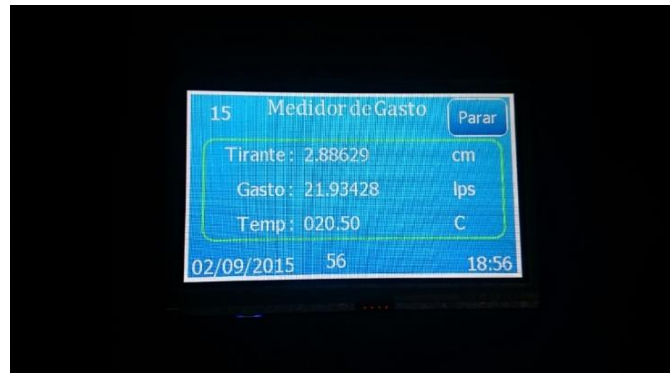
Figura 4.19 Ejemplo de registro de información de un sensor ultrasónico durante la presencia de un evento de escurrimiento
