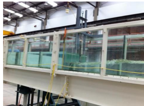
Figura 4.32 Pruebas experimentales descarga ahogada y libre
