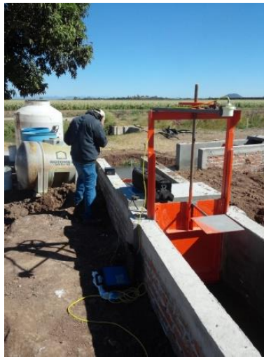
Figura 4.42 Puesta en marcha de equipo de medición para pruebas de envío de información
