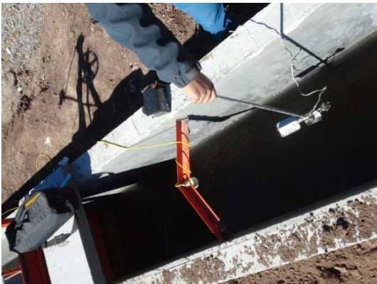
Figura 4.41 Aforo con molinete para obtención de gasto y parámetros de configuración de riego y de estructura de medición
