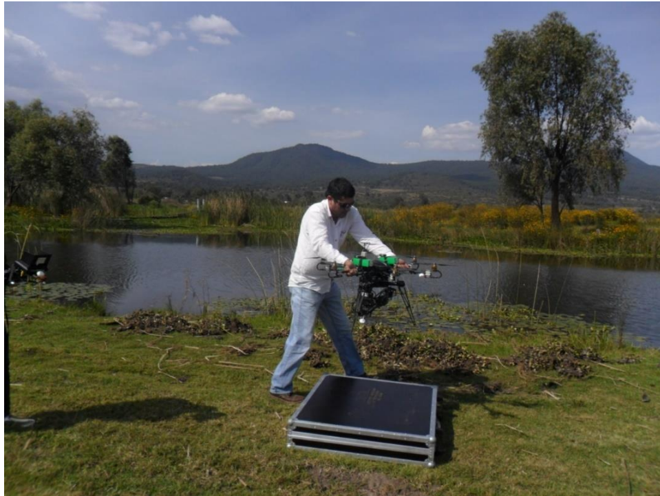
Figura 4.18 Calibración de la brújula: giro horizontal respecto al eje del dron
