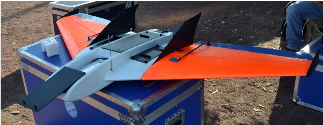
Figura 3.8 Dron de ala fija
