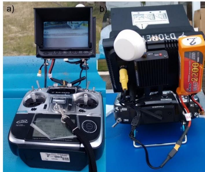
Figura E.19 a) Emisoras y b) Conexión de batería al monitor
