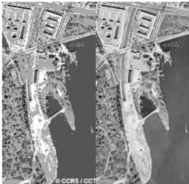
Figura 3.34 Comparación de dos imágenes de diferente resolución 2 bits (izquierda) y 8 bits (derecha) (CCRS, 2016)
