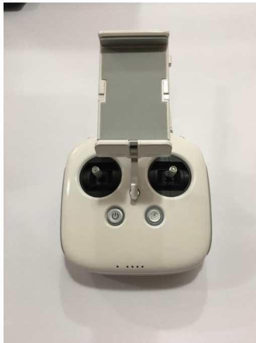
Figura B.7 Radiocontrol de un dron Phantom 4 de DJI. Se puede apreciar el soporte para Tablet o celular, que no viene incluido con el control
