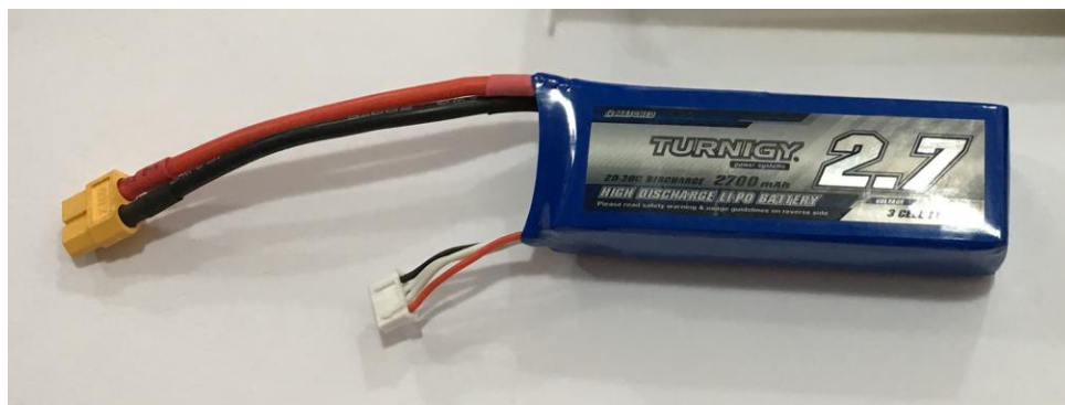
Figura B.5 Batería de litio-polímero de 3 celdas del dron Cheerson CX20
