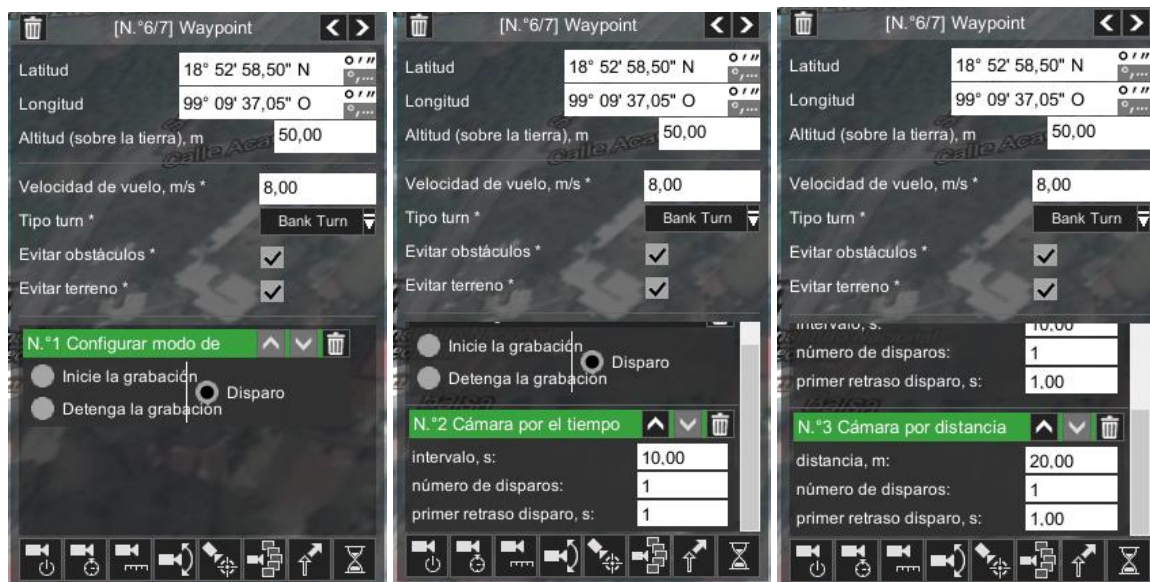
Figura D.21 Configuración cámara para el Waypoint 6. A) modo de cámara, B) cámara por tiempo, C) cámara por distancia
