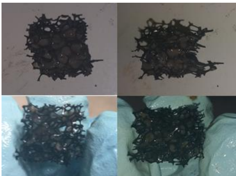
Figura 4.4. Desarrollo de la biomasa en un soporte de cubos de poliuretano. Fuente (Elaboración propia).
