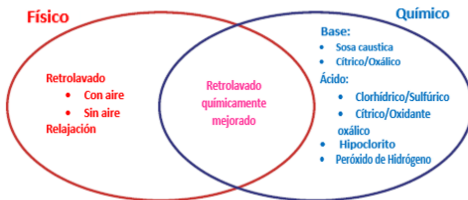
Figura 3.12. Método para la limpieza de membranas. Adaptado de (Judd, 2006).
