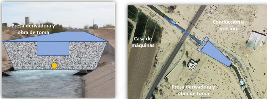
Figura 8.3. Propuesta 2. Presa derivadora en 3era caída en planta
