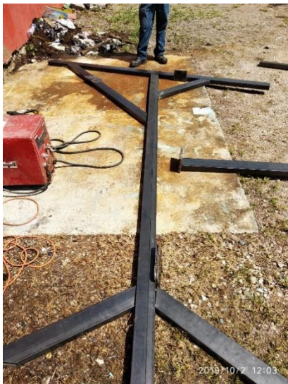
Ilustración 37 Presentación de piezas antes de soldar.
