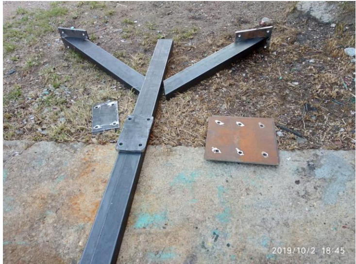
Ilustración 37 Presentación de piezas antes de soldar.
