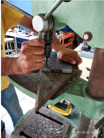
Ilustración 36 Perforación de las placas de sujeción y anclaje.
