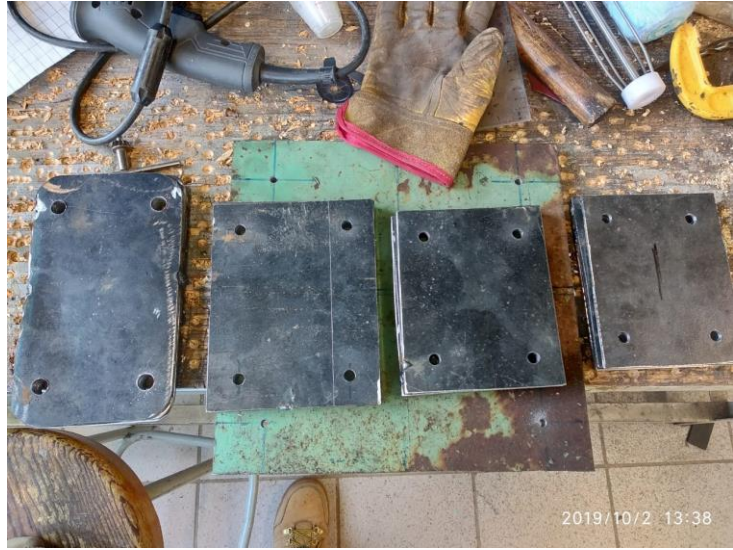
Ilustración 36 Perforación de las placas de sujeción y anclaje.
