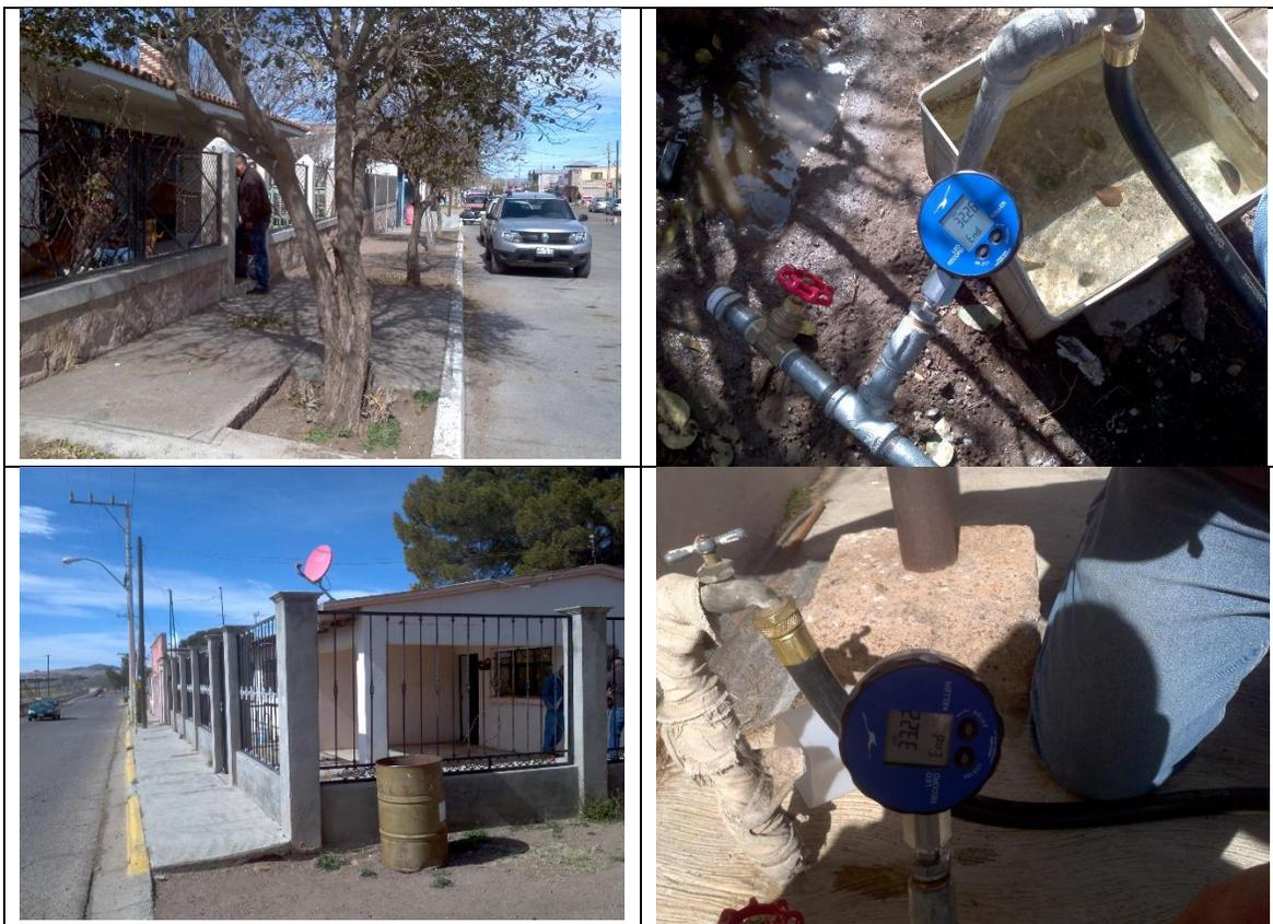
**Ilustración 51 Levantamiento de presiones en campo en la Calle Mina, 1° de mayo y Topolobampo**
