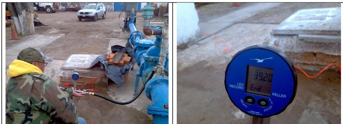
**Ilustración 35 Presión registrada en el pozo #1 con la carga del tanque de distribución.**
