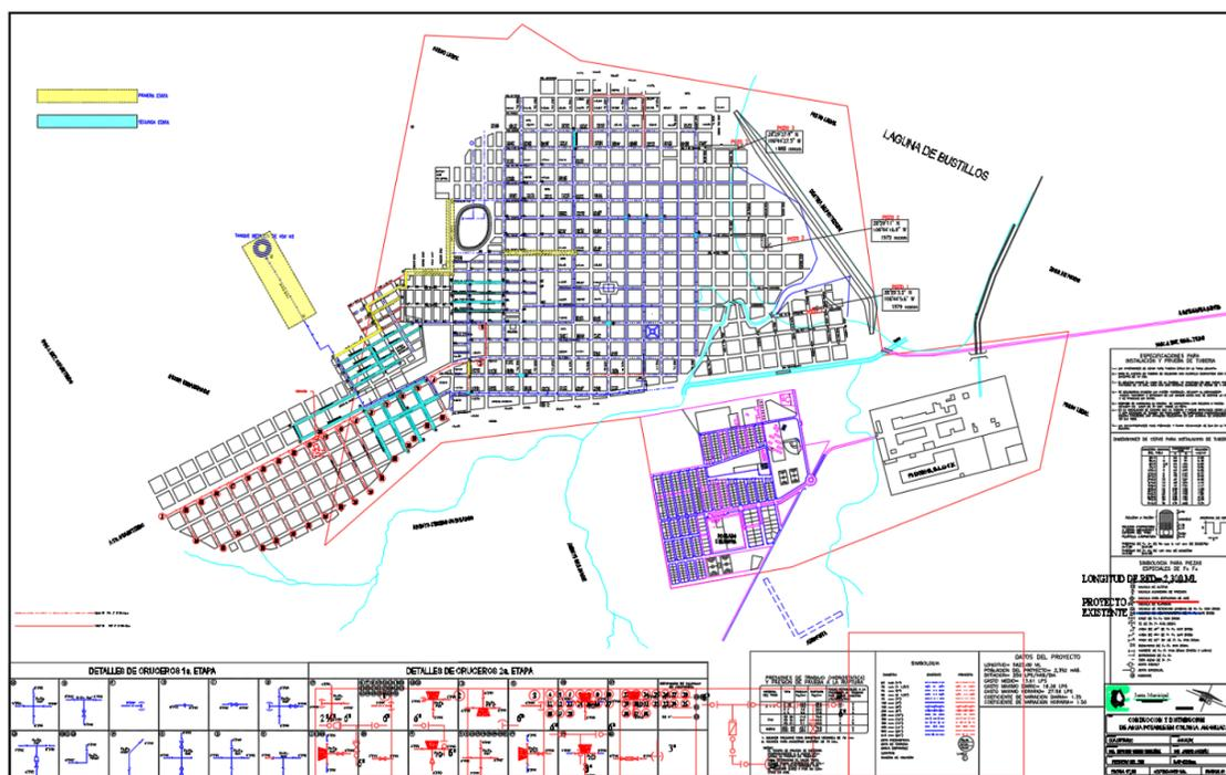
**Ilustración 10. Plano de la red de agua potable (existente y proyecto), JMÁS Cuauhtémoc 2003.**
