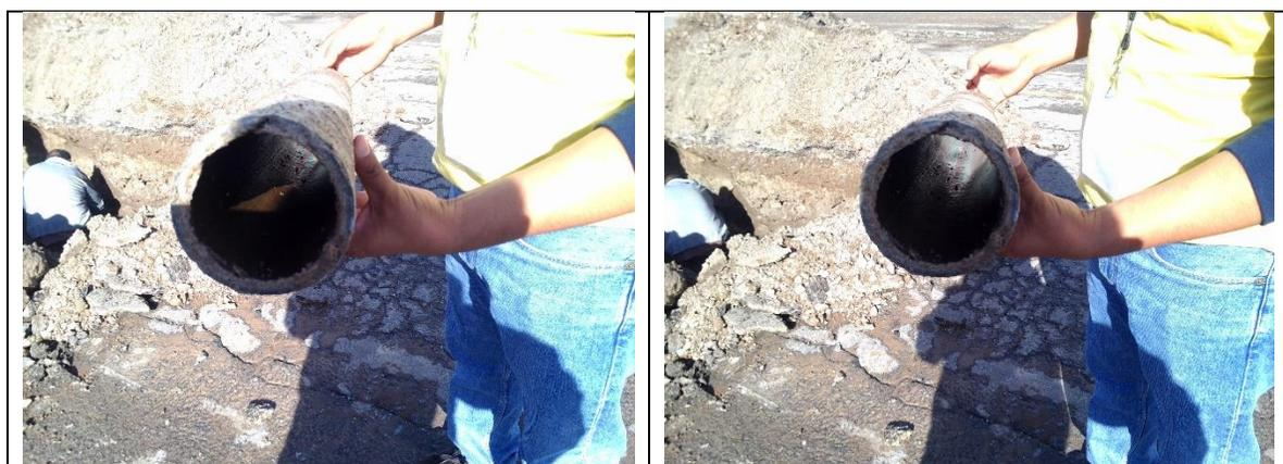
**Ilustración 56 El tubo presenta un color café en todo su interior, se observa resistente.**
