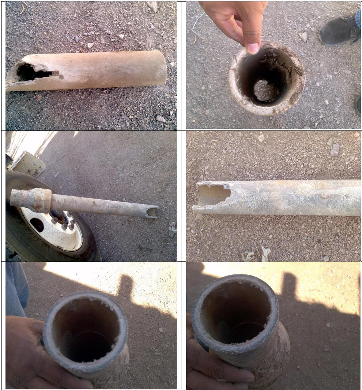
**Ilustración 28 Tubos con fisura longitudinal ocasionando fugas de agua y espesor sano.**
