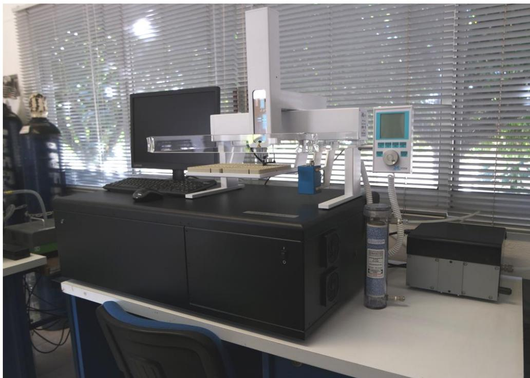
**Figura 65** Analizador Laser Modelo LIWA-45-EP Instalado en el laboratorio de espectrometría de masas del IMTA
