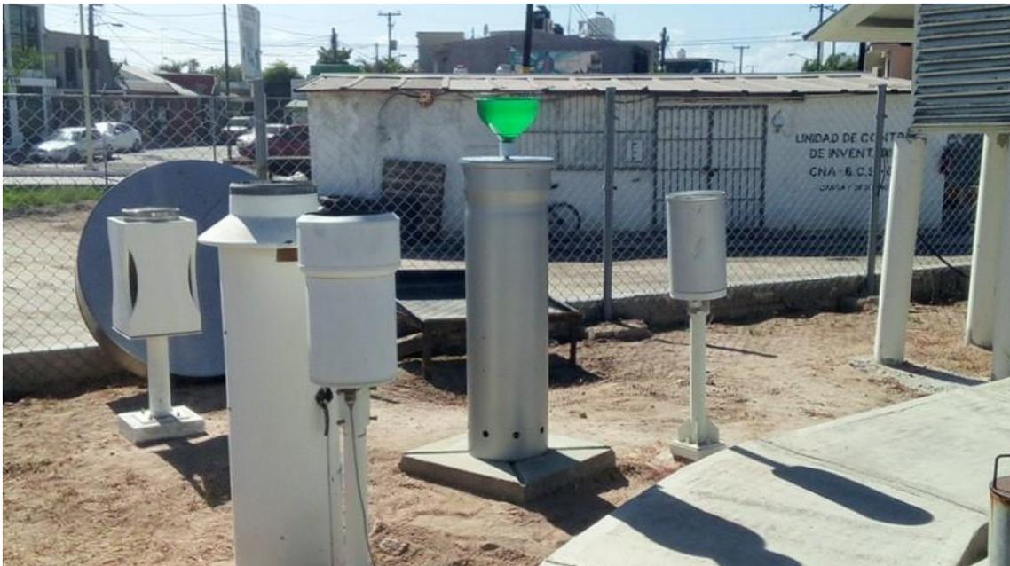
**Figura 42** Colector de lluvia en el Observatorio La Paz. BCS
