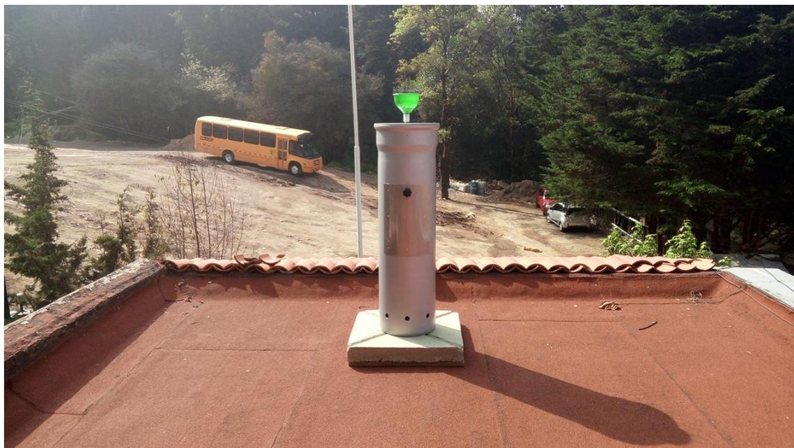
**Figura 50** Colector de lluvia en la Estación pluviométrica La Venta. CDMX
