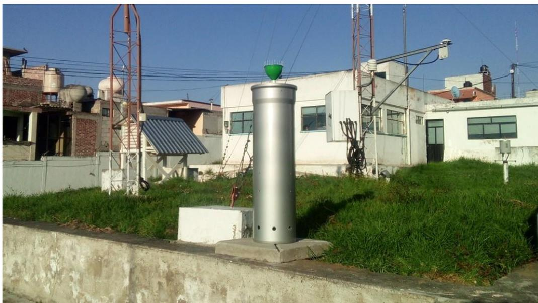
**Figura 34** Colector de lluvia en el Observatorio Tulancingo. Hidalgo
