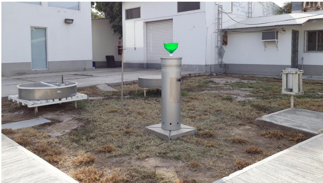
**Figura 44** Colector de lluvia en el Observatorio Torreón. Coahuila
