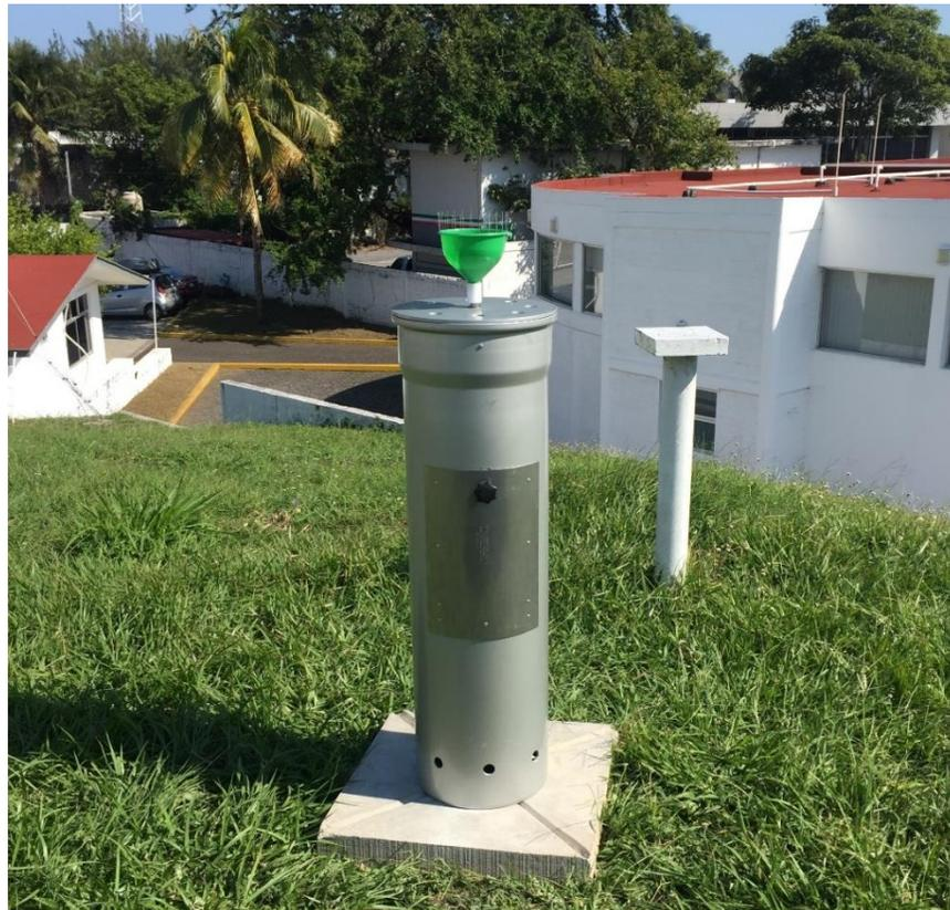
**Figura 25.** Colector totalizador de la precipitación pluvial, Mod. RS2 PALMEX
