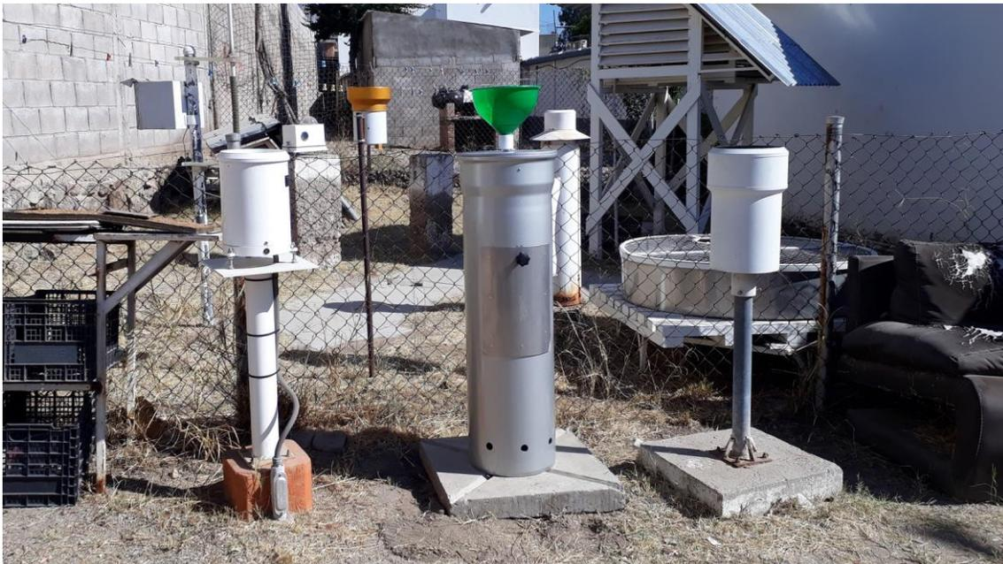
**Figura 38** Colector de lluvia en el Observatorio Hermosillo. Sonora
