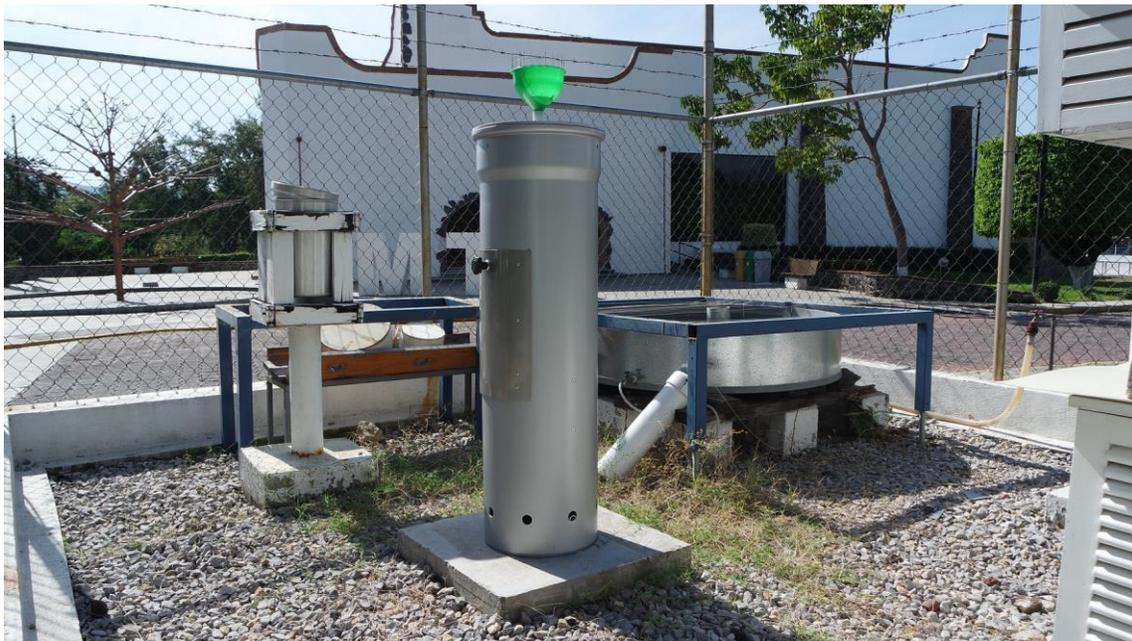
Figura 56 Colector de lluvia en el IMTA. Morelos
