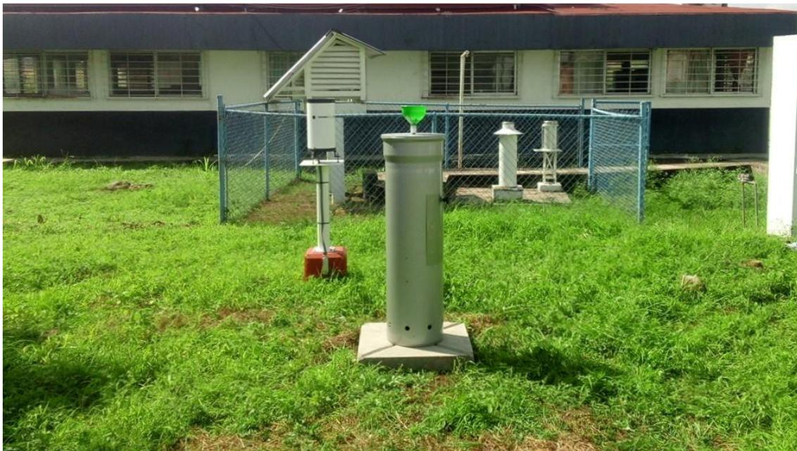
**Figura 48** Colector de lluvia en el Observatorio Tapachula. Chiapas
