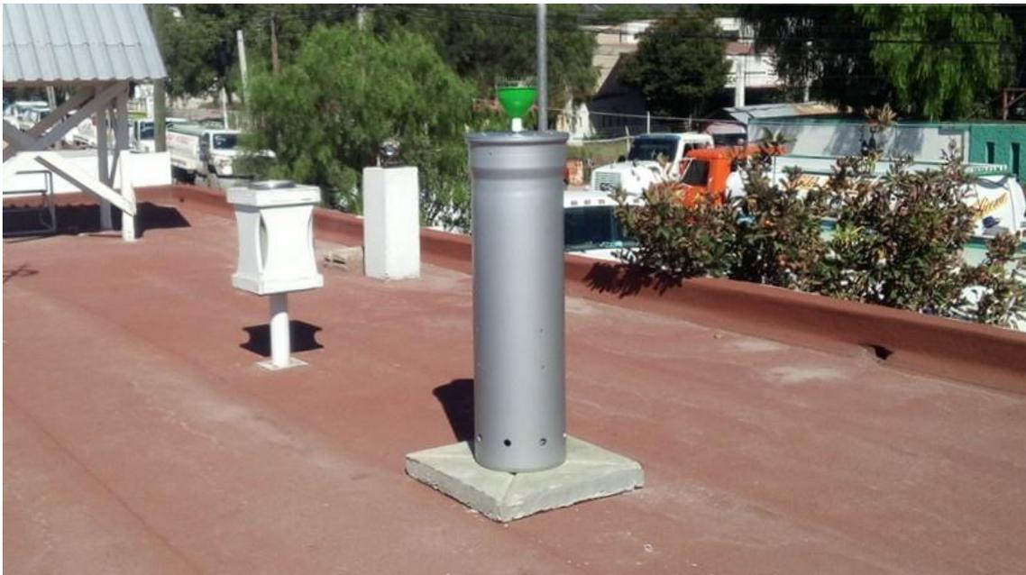
**Figura 32** Colector de lluvia en el Observatorio Pachuca. Hidalgo
