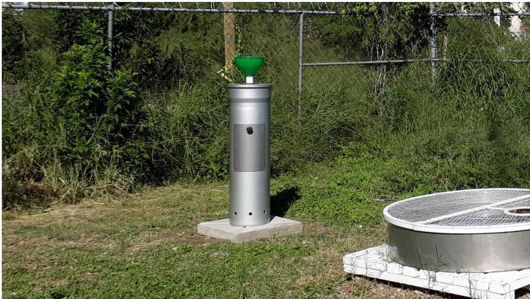
Figura 36 Colector de lluvia en el Observatorio Cd. Victoria. Tamaulipas
