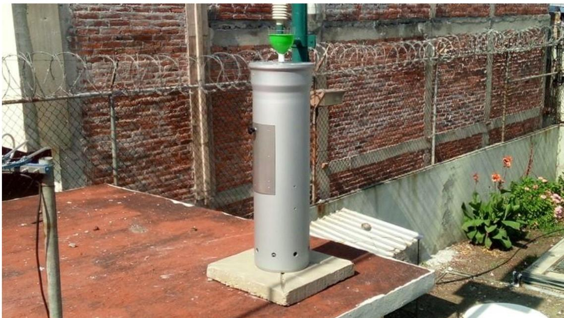
**Figura 54** Colector de lluvia en la Estación pluviométrica Tetelco. CDMX
