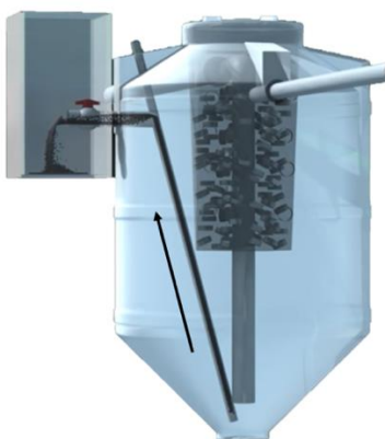
Figura 1.9. Modo de expulsión de sólidos en el biodigestor Rotoplas
