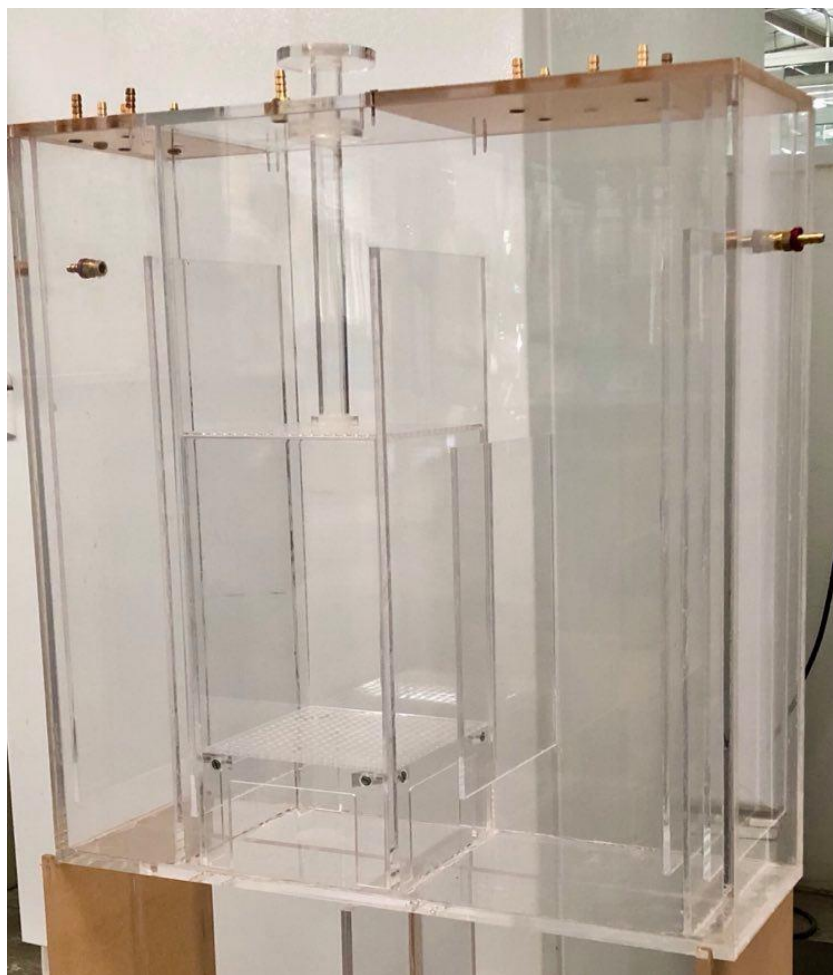
Figura 3.1. Elaboración del sistema de tratamiento con material de acrílico
