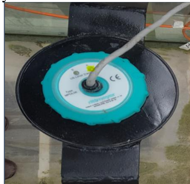
Ilustración 7: LED en color verde, sensor de nivel.
