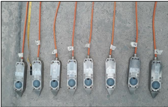
Ilustración 55: Cuatro pares de transductores ultrasónicos, intrusivos, de técnica tiempo de travesía (1MHz).
