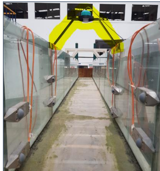
Ilustración 5: Sensor de nivel, montado con una base sobre un canal rectangular de laboratorio.
