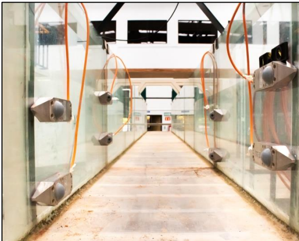
Ilustración 61: Sistema multi par de transductores montados en un arreglo en Z. Vista transversal.
