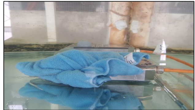
Ilustración 58: Medición del gasto en escenario de falla simulado con un transductor cubierto para evitar la salida de la señal ultrasónica.
