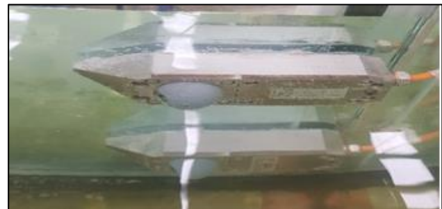
Ilustración 59: Medición del gasto en escenario de falla simulado con un transductor cubierto por burbujas para evitar la salida de la señal ultrasónica.
