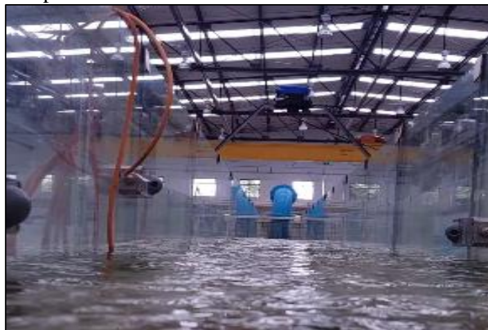
Ilustración 12: Transición de estado seco a húmedo de un sensor ultrasónico.
