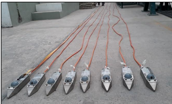
Ilustración 56: Cuatro pares de transductores ultrasónicos, tiempo de travesía. Medición de la longitud del cable.
