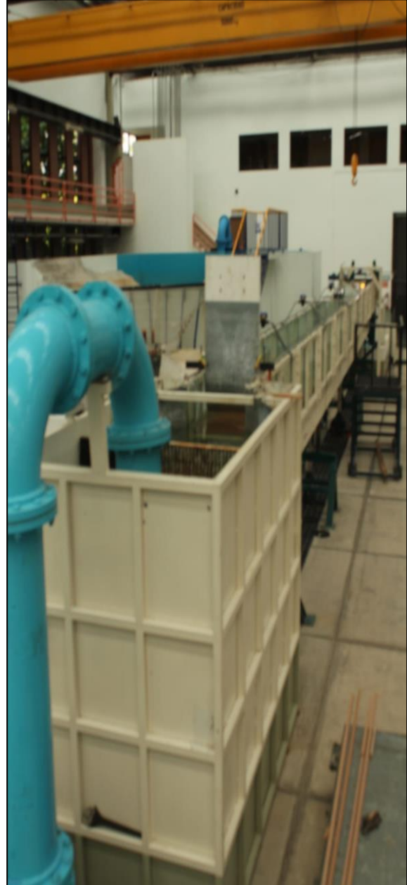
Ilustración 76: Suministro del gasto con una bomba por medio de un cuello de ganso.
