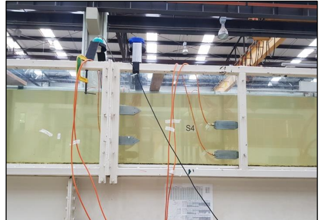
Ilustración 57: Cuatro pares de transductores ultrasónicos, tiempo de travesía, instalados en un canal de vidrio (60x70 cm).
