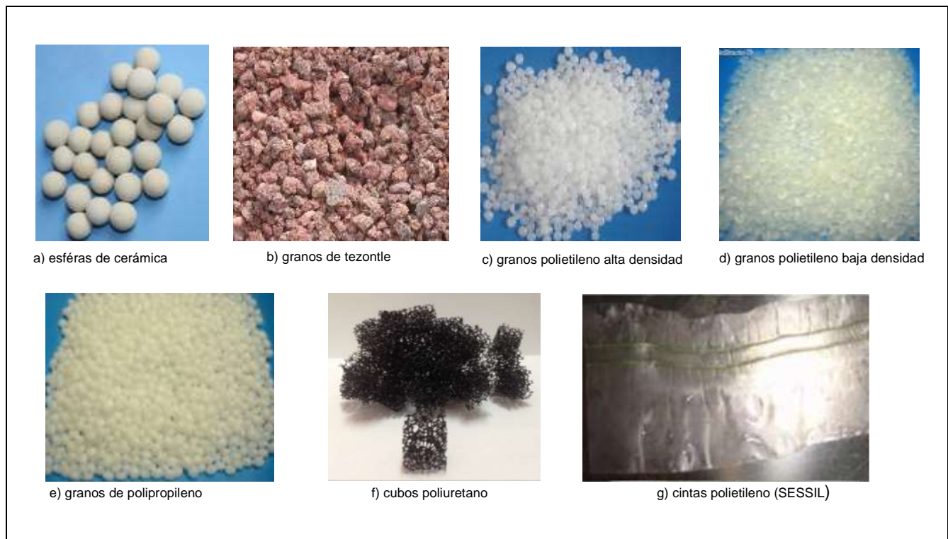
Figura 1.13 Ejemplos de materiales de empaque utilizados en biorreactores.
