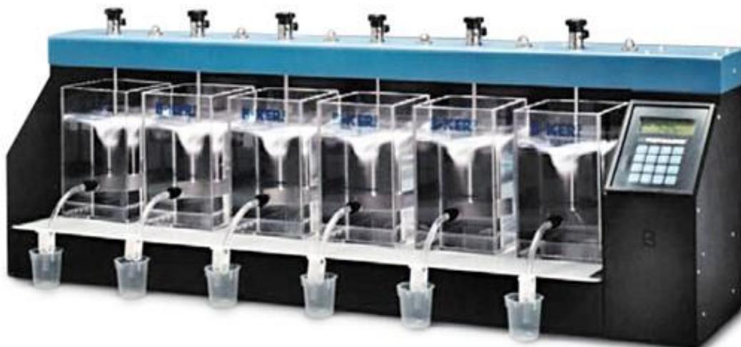
**Figura 10. Equipo de prueba de Jarras utilizado en la experimentación para el proceso de floculación.**
