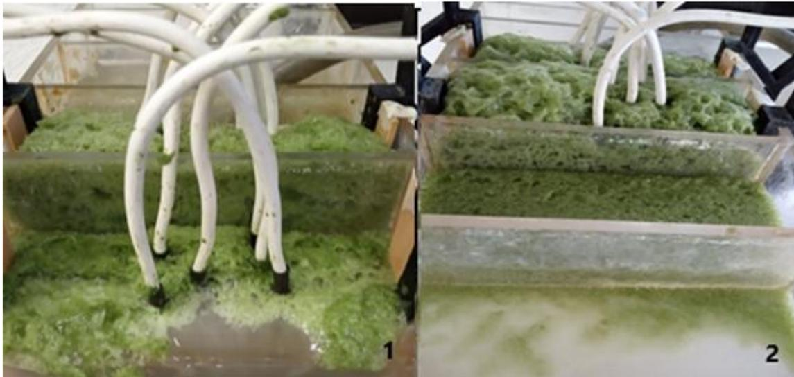
**Figura 9. Diferencia entre los reactores de Electrocoagulación (1) y Electroflotación (2); acomodo de los electrodos al final o al inicio del dispositivo**
