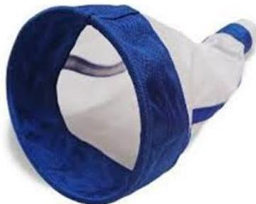
**Figura 5. Red para fitoplancton (20  $\mu\text{m}$ ) utilizada para la obtención de las microalgas.**
