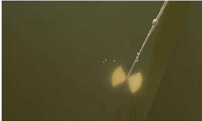
**Figura 4. Medida de la visibilidad (cm) con disco de Secchi.**
