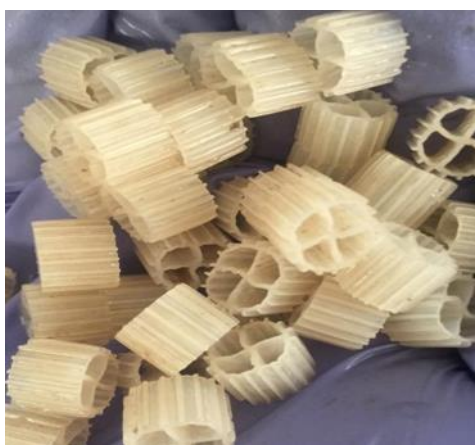
Figura 4.5. Soportes Kaldnes tipo KMT K1
