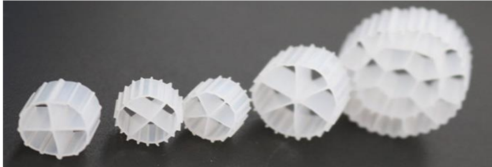
Figura 3.4. Soportes tipo Kaldnes, con divisiones al centro y crestas longitudinales que representan el área superficial donde se adjunta la biopelícula.
