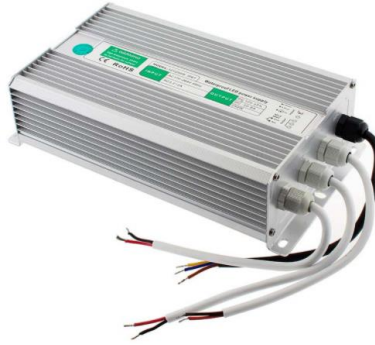
Figura 10. Fuente de alimentación DC 5 V de 20 A con protección IP67.
