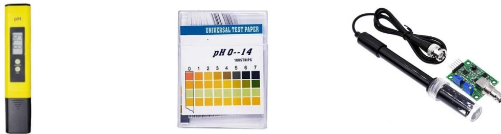
Figura 15. Medidores de pH y sensor.
