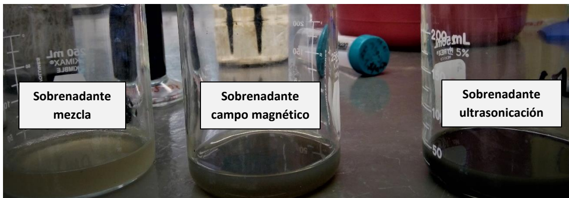
Fig. II.1. Sobrenadantes de las muestras de lodo pretratadas mediante campo magnético y ultrasonificación tras su centrifugación
