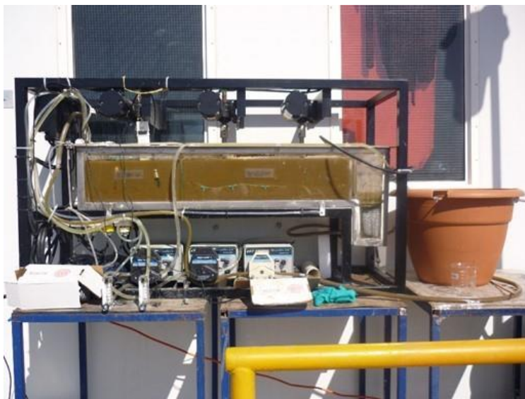
Figura 3-6 Vista frontal del proceso de lodos activados Ludzack-Ettinger convencional con sedimentador
