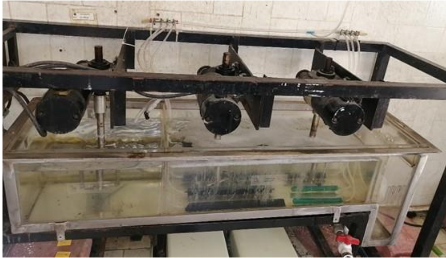
Figura 9-3. Pruebas de difusión y control de aire, monitoreo de agitador en tanque anóxico
