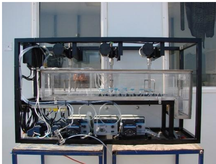
Figura 3-4. Vista frontal del proceso de lodos activados Ludzack-Ettinger convencional
