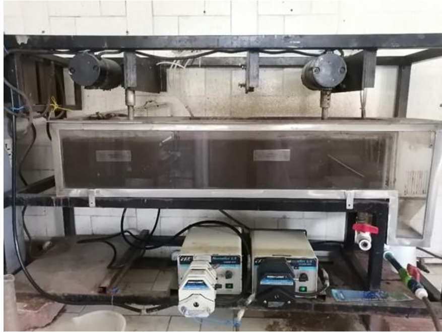
Figura 9-5. Tanque anóxico y aerobio
