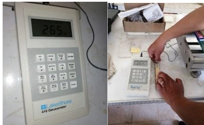
Figura 5-2 Medición de intensidad de campo magnético
