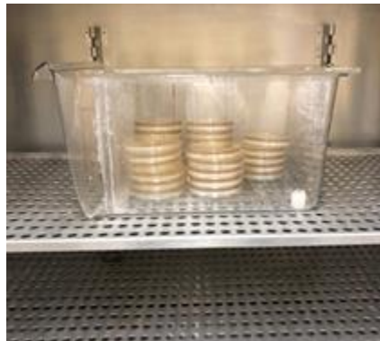
Figura 4.13. Cámara de anaerobiosis (Agares en incubación a 37 °C)
