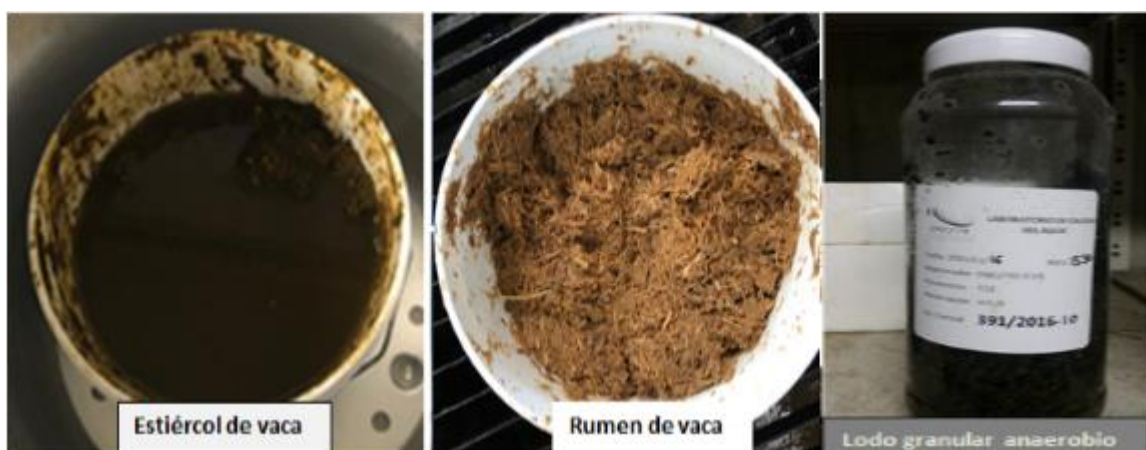
Figura 4.3. Aspecto físico de las tres fuentes ambientales para usarse como inóculos.
