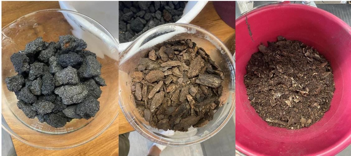
Figura 6 Materiales utilizados como empaque en los biofiltros: coque, trozos de madera, composta de jardín
