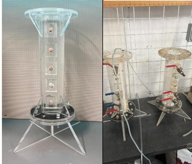
Figura 5 Reactores utilizados en la etapa de biofiltración
