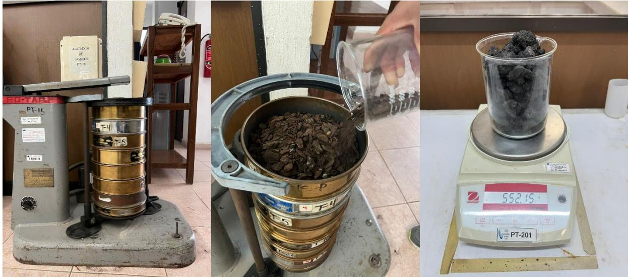
Figura 7 Tamizaje de los materiales filtrantes
