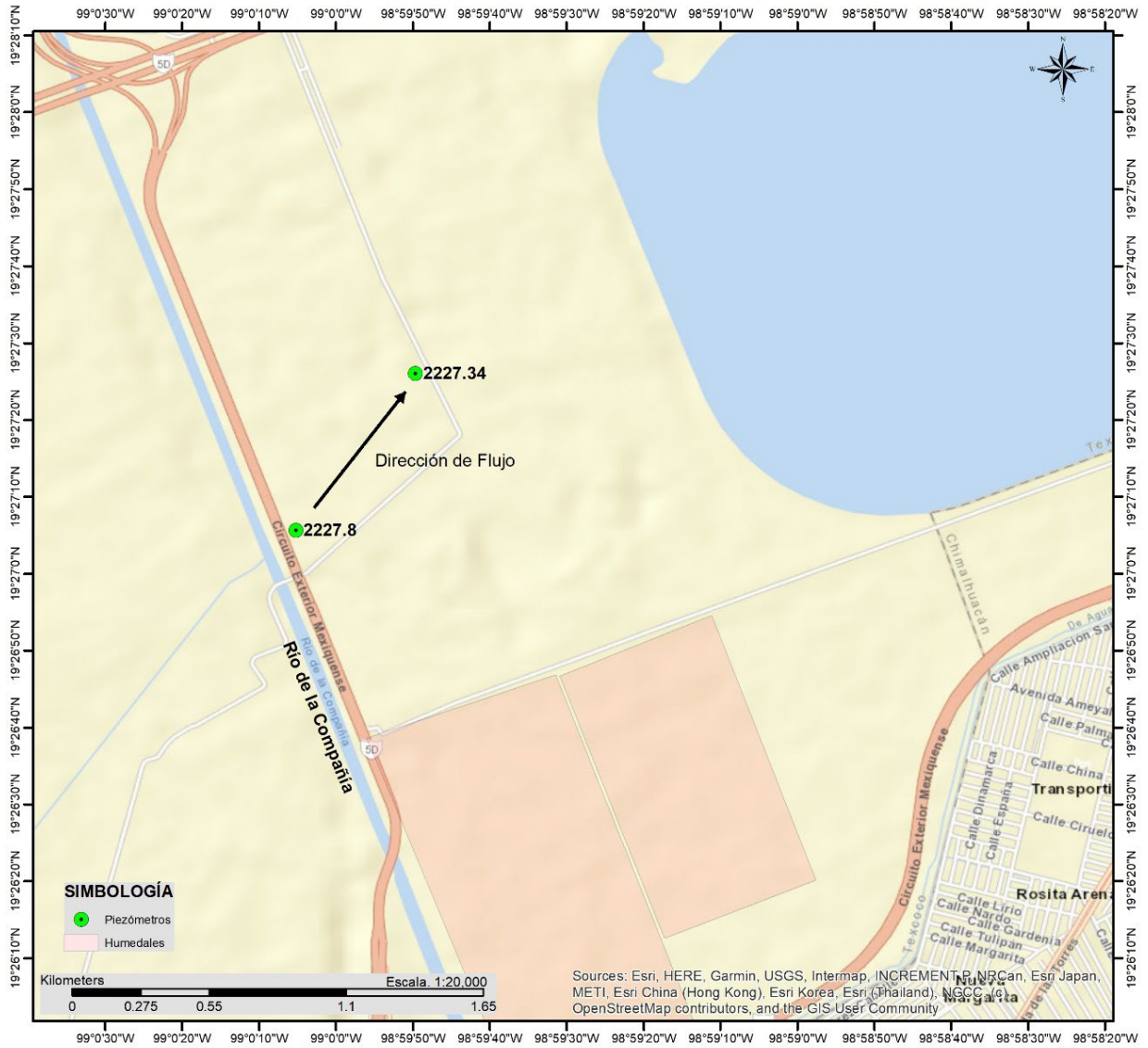
Figura 3-82. Dirección del flujo subterráneo
