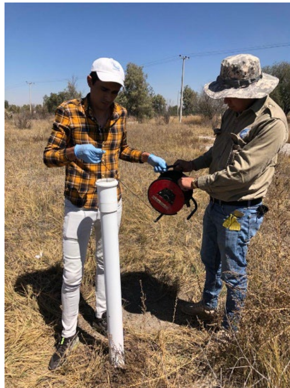
Figura 3-75. Medición del nivel estático en el piezómetro 29
