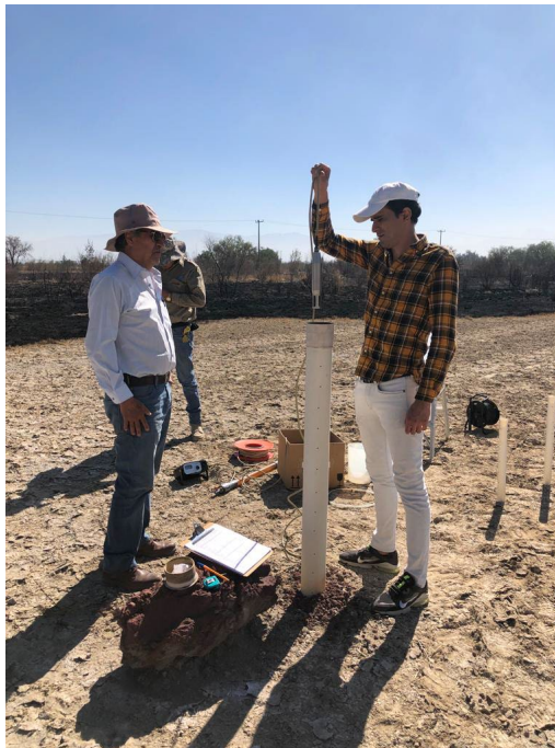
Medición de conductividad eléctrica
