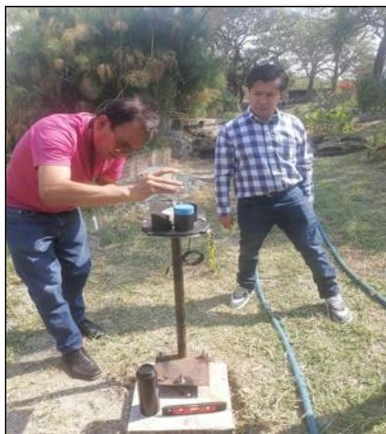
Ilustración 18. Instalación de pluviómetro totalizador en microcuenca
