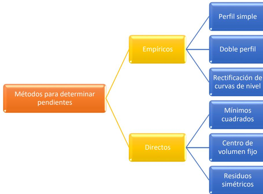
**Figura 2.19 Métodos para determinar pendientes.**
