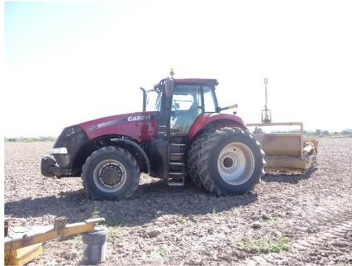
**Figura 2.42 Tractor de >213 CV, equipado con la estación móvil de nivelación GPS, utilizado en la nivelación.**
