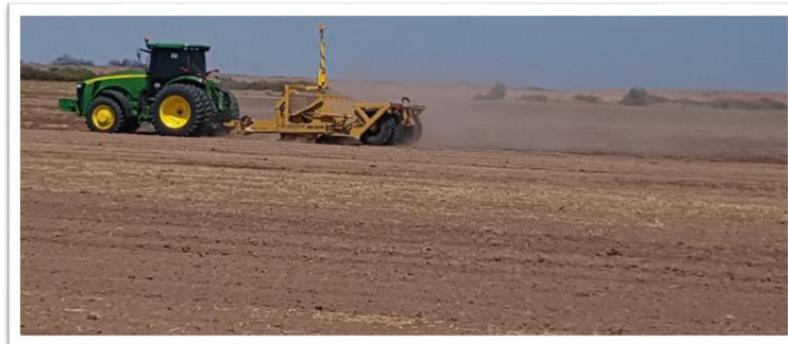
**Figura 2.66** Equipo haciendo las correcciones de nivelación.
