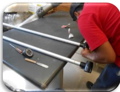
**Figura 6.3** Manipulación de medidor de hélice digital dañado y bueno en el Módulo 3.
