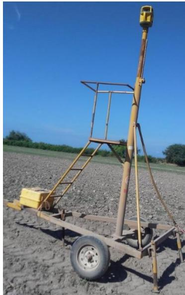
**Figura 2.39** Transmisor marca Trimble con el cual se llevaron a cabo los trabajos de nivelación de tierras.
