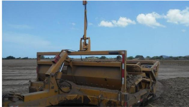
**Figura 2.40** Scraper capacidad 12 yardas la cual cubrió los trabajos de nivelación de tierras.
