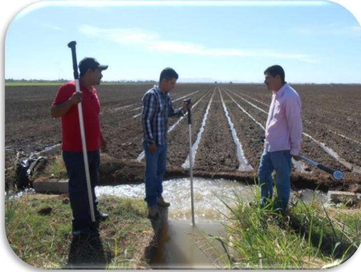
Figura 6.5 Verificación de medidor de hélice digital reparado y bueno en el Módulo 3.
