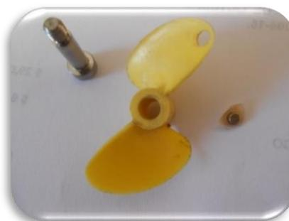
**Figura 6.2** Hélice desensamblada de medidor digital dañado en el Módulo 3.
