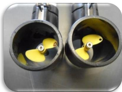
**Figura 6.1** Medidor de hélice digital dañado y bueno en el Módulo 3.
