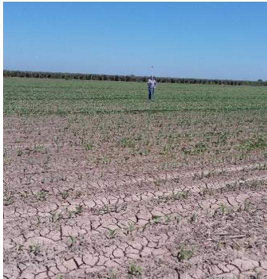
**Figura 2.49 Lectura de desnivel con el estadal en dos puntos adelante y atrás**
