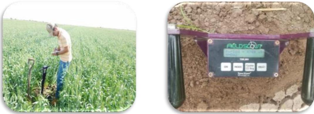
Figura 4.1 Medición de la humedad con TDR.
