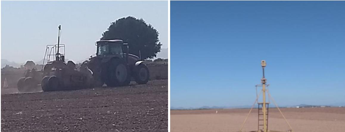
Figura 2.46 Emisor y receptor laser de la máquina de la nivelación de tierras.
