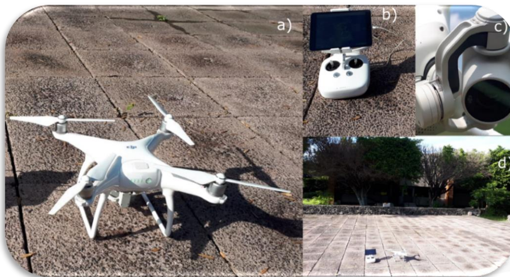
Figura 5.15 Imágenes del equipo: a) fuselaje, b) control, c) carga útil y d) zona de despegue
