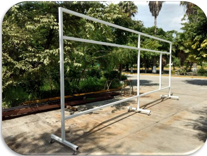
Figura 4.19 Base de herrería, para soporte de los subsistemas hidropónicos
