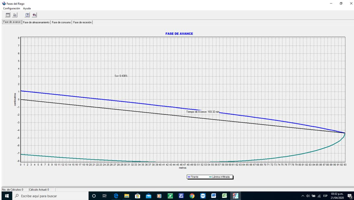
Figura 33. Fase de avance en la selección del gasto óptimo con el Rigrav 3.0
