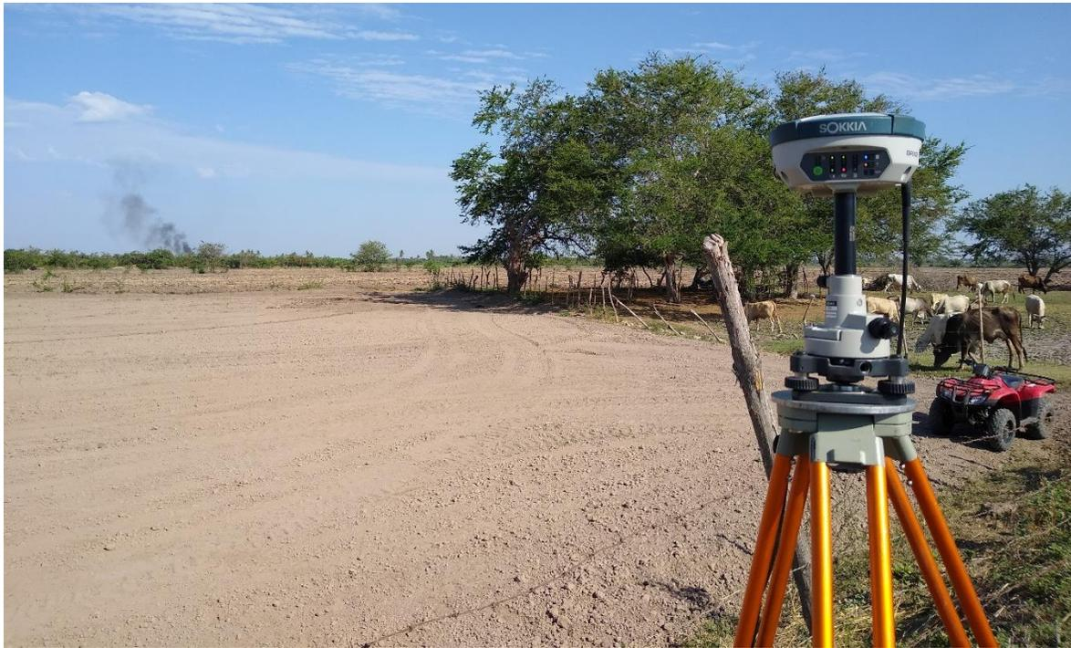
Figura 16. GPS diferencial con tecnología RTK de la marca SOKKIA, modelo GRX2.
