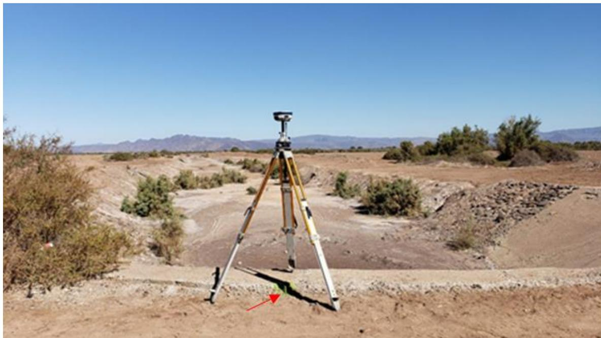
Figura 53. Localización del Banco de Nivel (BN) e instalación del GPS
