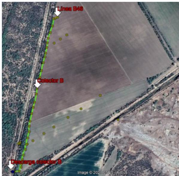
Figura 26. Localización del colector subterráneo parcelario B, su descarga y el dren subterráneo parcelario B46.
