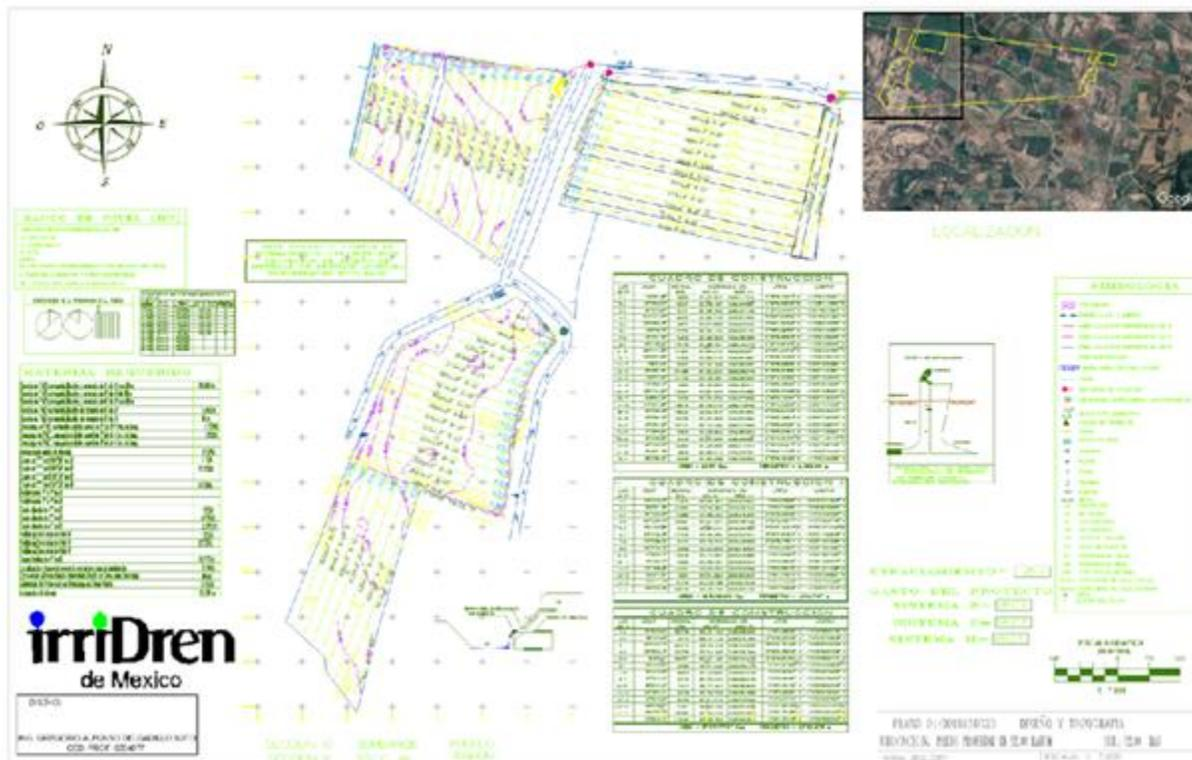
Figura 35. Plano de diseño de sistemas de drenaje subterráneo parcelario de 53.00 hectáreas.
