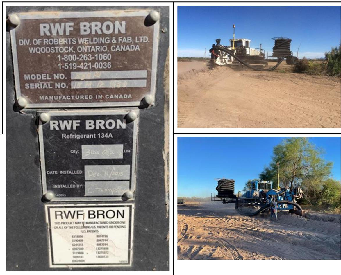
Figura 60. Zanjadoras utilizadas en la instalación de sistemas de drenaje subterráneo parcelario
