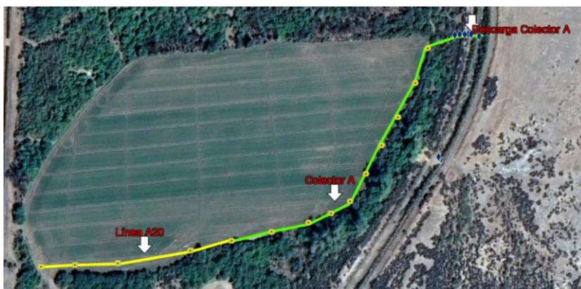
Figura 1. Localización del colector parcelario A, así como su descarga y dren parcelario A20.
