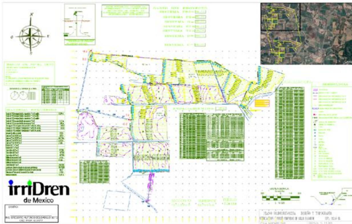
Figura 37. Plano de diseño de sistemas de drenaje subterráneo parcelario de 193.50 hectáreas.
