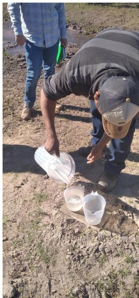
Figura 99. Obtención del gasto evacuado por el sistema de drenaje.
