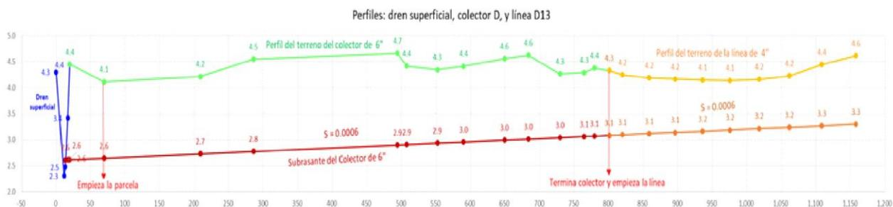
Figura 9. Perfil longitudinal del colector subterráneo parcelario D y del dren subterráneo parcelario D13.
