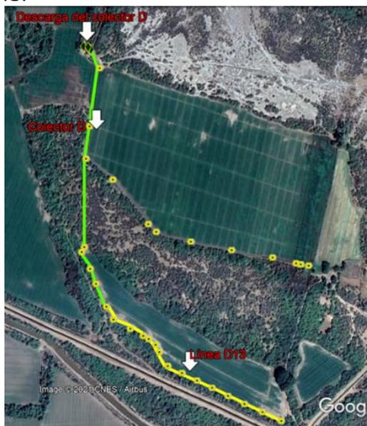
Figura 8. Localización del colector subterráneo parcelario D, así como su descarga y dren subterráneo parcelario D13.
