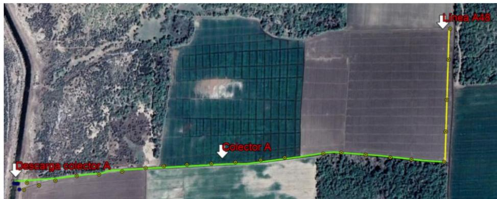
Figura 18. Localización del colector subterráneo parcelario A, su descarga y del dren subterráneo parcelario A48.
