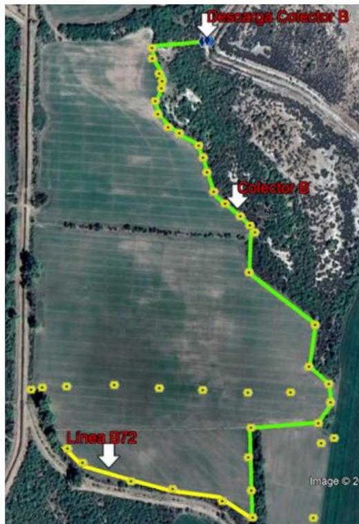
Figura 3. Localización del colector subterráneo parcelario B, así como su descarga y dren subterráneo parcelario B72.
