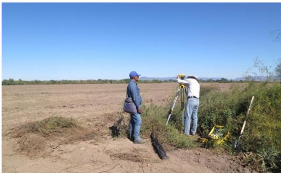
Figura 68. Establecimiento de base de referencia para la supervisión de la instalación
