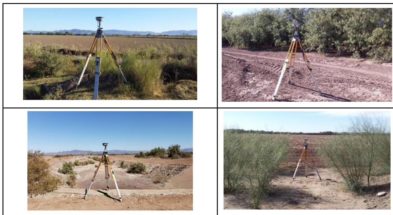
Figura 66. Bancos de referencia para el trazo de instalación
