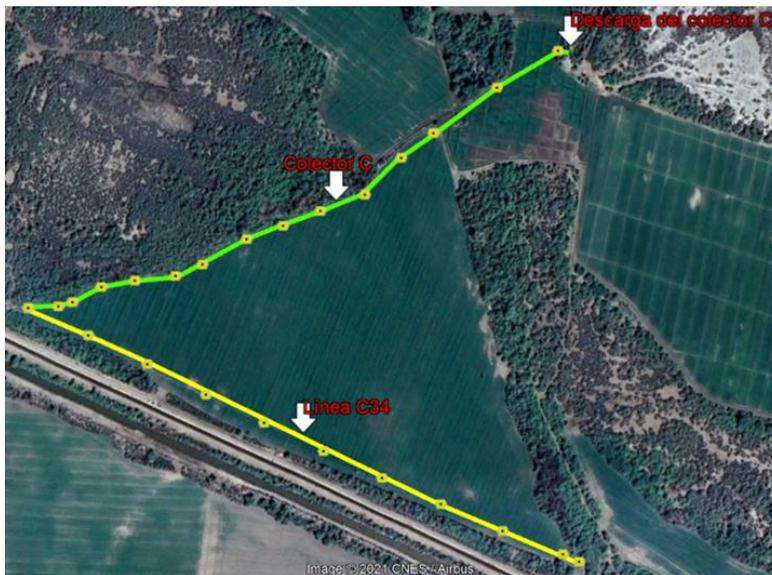
Figura 6. Localización del colector subterráneo parcelario C, así como su descarga y dren subterráneo parcelario C34.
