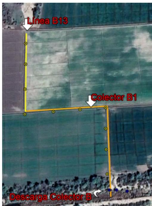
Figura 20. Localización del colector subterráneo parcelario B (B1), su descarga y del dren subterráneo parcelario B13.
