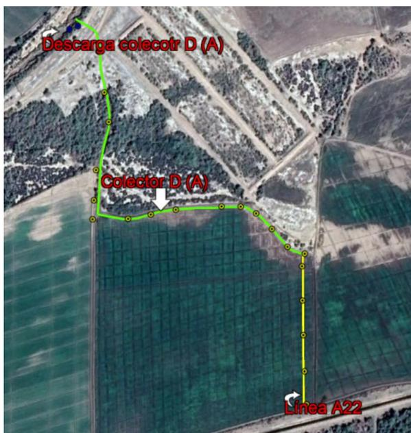
Figura 24. Localización del colector subterráneo parcelario D (A), su descarga y del dren subterráneo parcelario A22.
