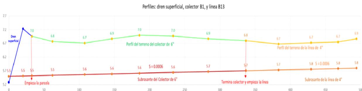
Figura 21. Perfil longitudinal del colector subterráneo parcelario B (B1) y dren subterráneo parcelario B13.
