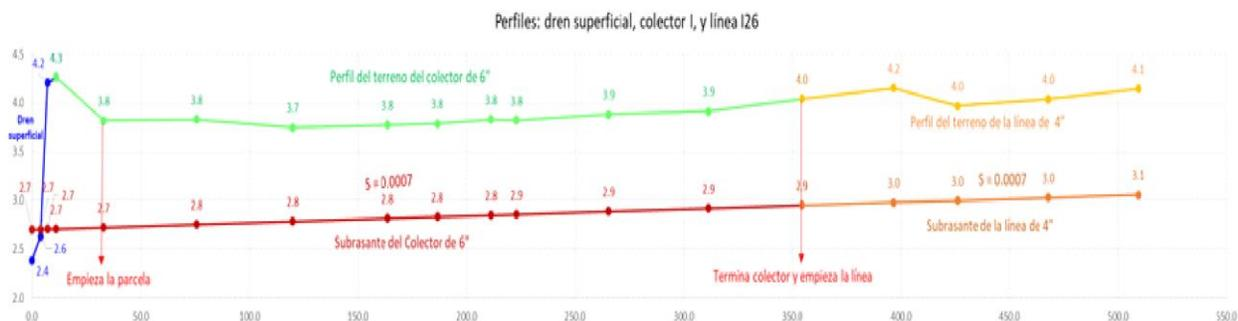
Figura 17. Perfil longitudinal del colector subterráneo parcelario I y el dren subterráneo parcelario I26.
