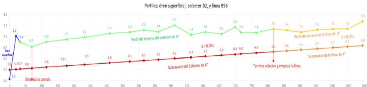
Figura 23. Perfil longitudinal del colector subterráneo parcelario B (B1) y dren subterráneo parcelario B13.
