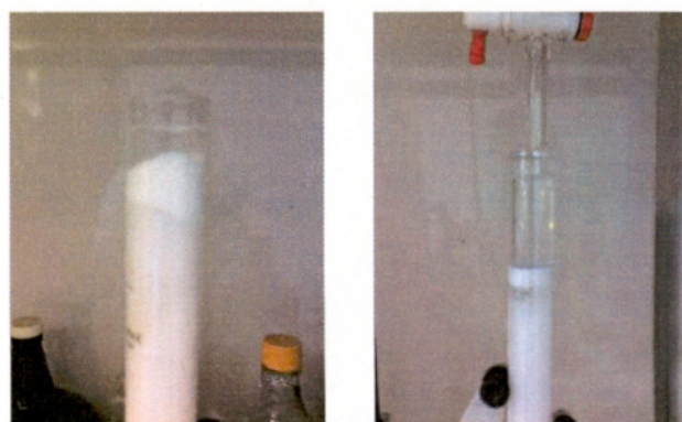
Figura 7.9 Columna cromatográfica utilizada para la purificación del hapteno
