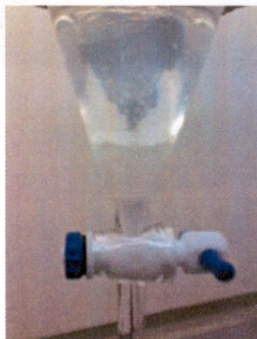
Figura 7.3 Separación de la fase orgánica y acuosa de la primera etapa de reacción
