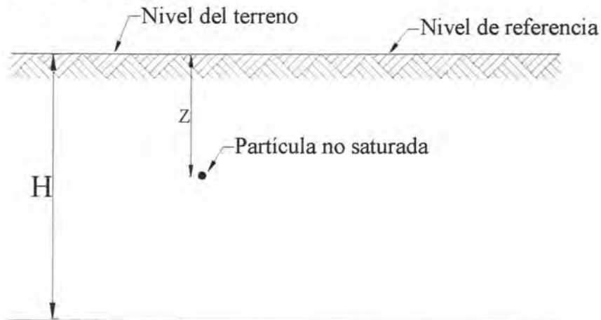
Figura 2.1. Ilustración de la posición de la partícula en relación con el nivel de referencia.
