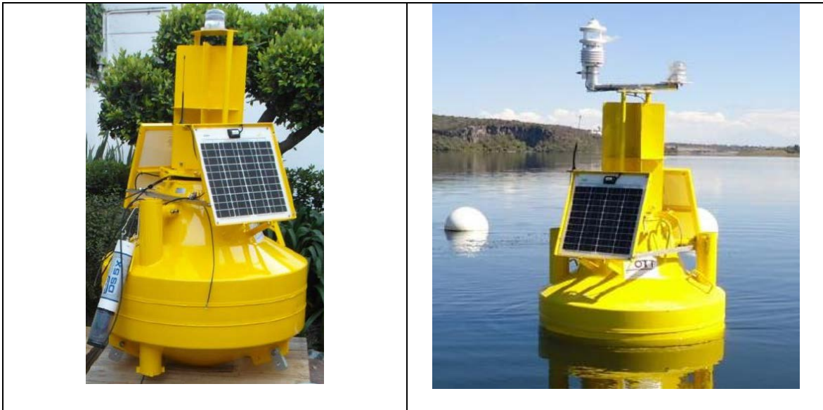
Figura 27. Boya instalada en la presa Manuel Ávila Camacho, se observan paneles solares y señalización
