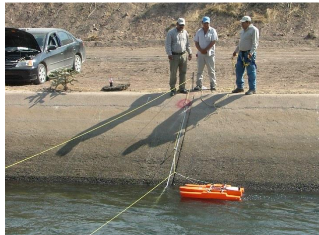
Arreglo de cuerdas y poleas para poder mover un PD en un canal profundo
