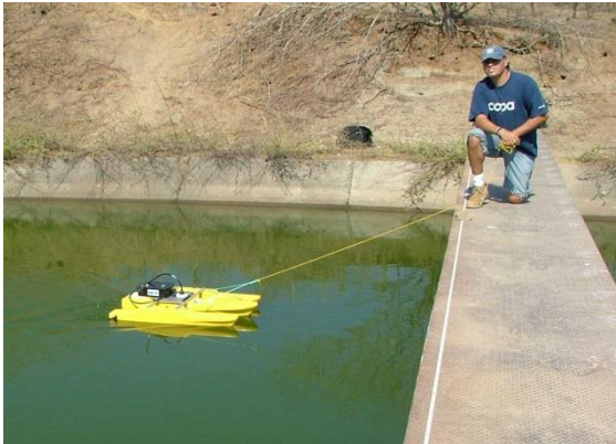
Aforo desde un puente y en modo "estacionario"
