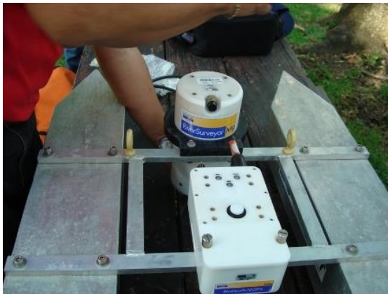
c. Ajuste del PD-M9 para garantizar que esté sumergido cuando se lleve al agua
