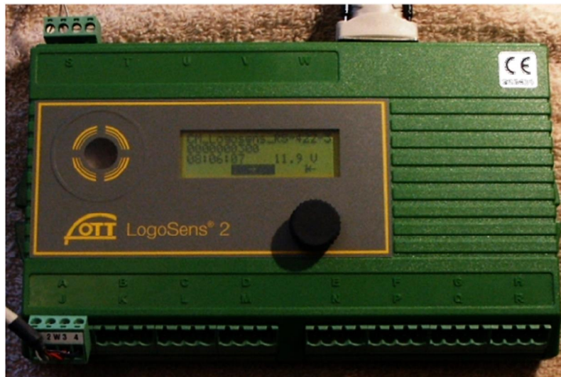
Figura 1.9 Mostrando el voltaje de la batería del Logosens
