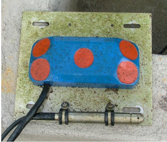
"ADF Pro 20" (marca ISCO) acoplado a un sensor de presión manométrico (marca KPsi)
