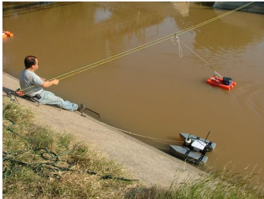
Aforo con PD desde una cuerda y en modo "dinámico"
