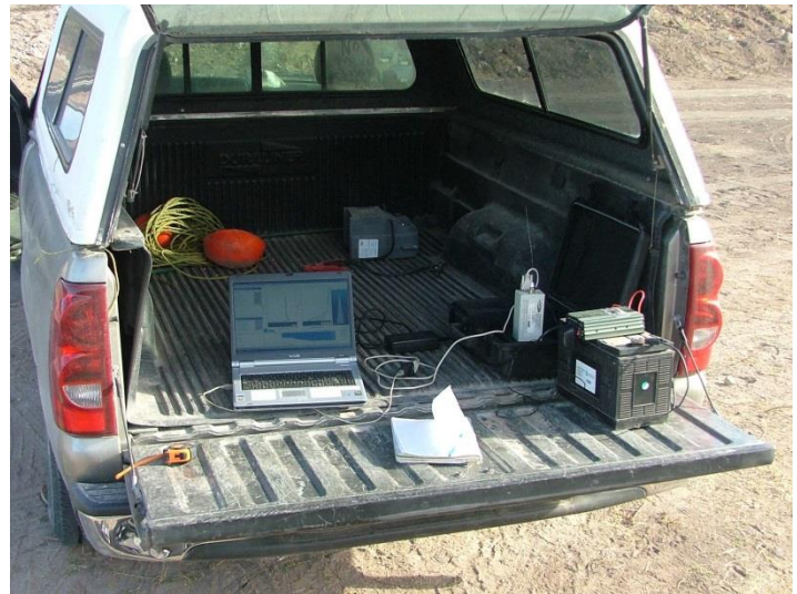
Laptop, radio-modem, batería e inversor para poder recibir los datos de un PD
