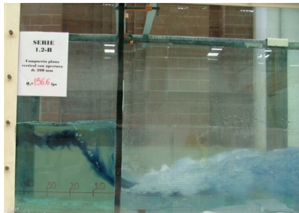
Figura 37. SERIE 1.2-B: a= 0.20 m, Y=0.40 m
