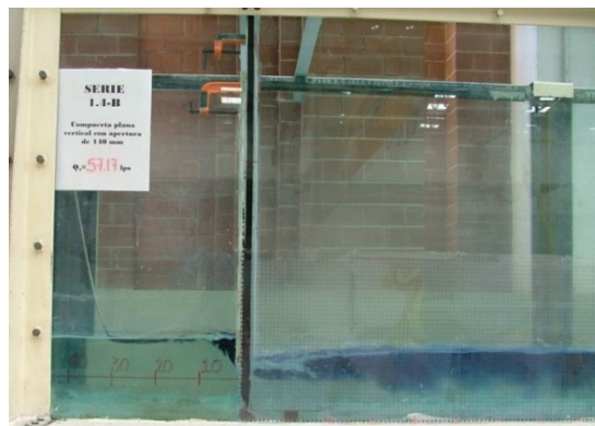
Figura 39. SERIE 1.4-B: a=0.14 m, Y=0.20 m
