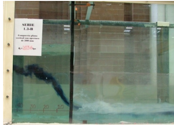
Figura 38. SERIE 1.3-B: a=0.20 m, Y=0.60 m
