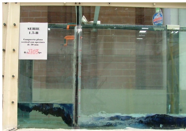
Figura 42. SERIE 1.7-B: a=0.05 m, Y= 0.20 m
