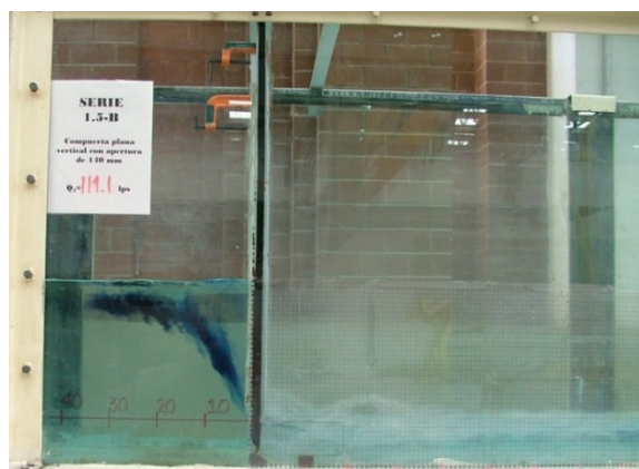
Figura 40. SERIE 1.5-B: a=0.14 m, Y=0.40 m
