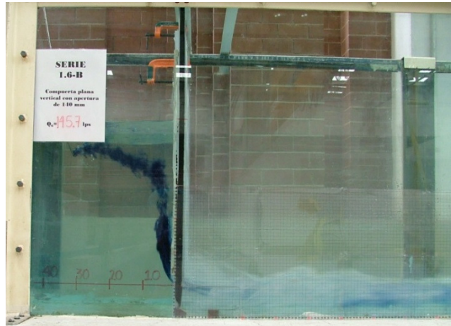
Figura 41. SERIE 1.6-B: a=0.14 m, Y=0.60 m
