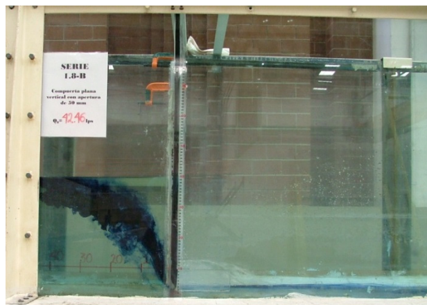
Figura 43. SERIE 1.8-B: a=0.05 m, Y=0.40 m
