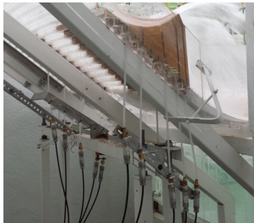
Figura 103. Distribución de Sensores en los deflectores.
