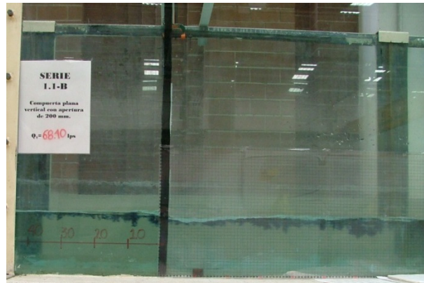
Figura 36. SERIE 1.1-B: a= 0.20 m, Y=0.20 m
