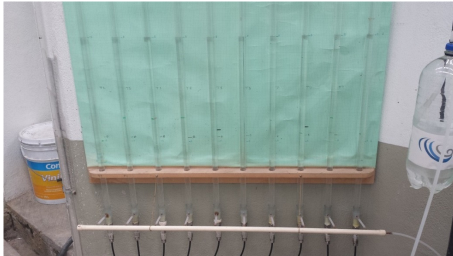
Figura 106. Tablero de piezómetros, con alimentador de vasos comunicantes.
