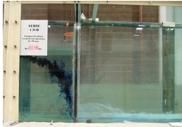
Figura 44. SERIE 1.9-B: a=0.05 m, Y=0.60 m
