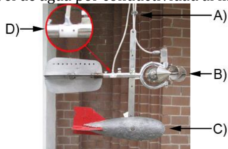
Figura 5. Sistema escandallo-molinete, A) Cable de acero, B) Molinete, C) Escandallo, D) Sensor de nivel.
