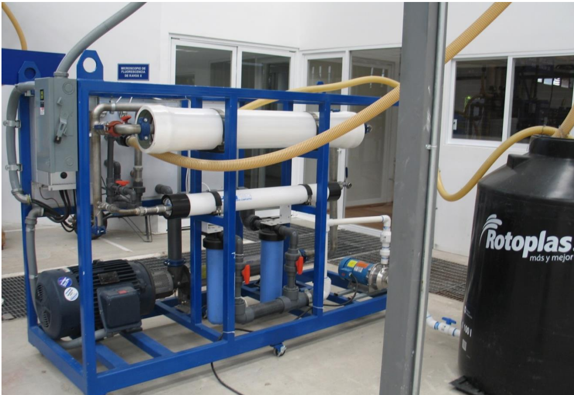
Ilustración 2.2. Banco de pruebas para una sola membrana
