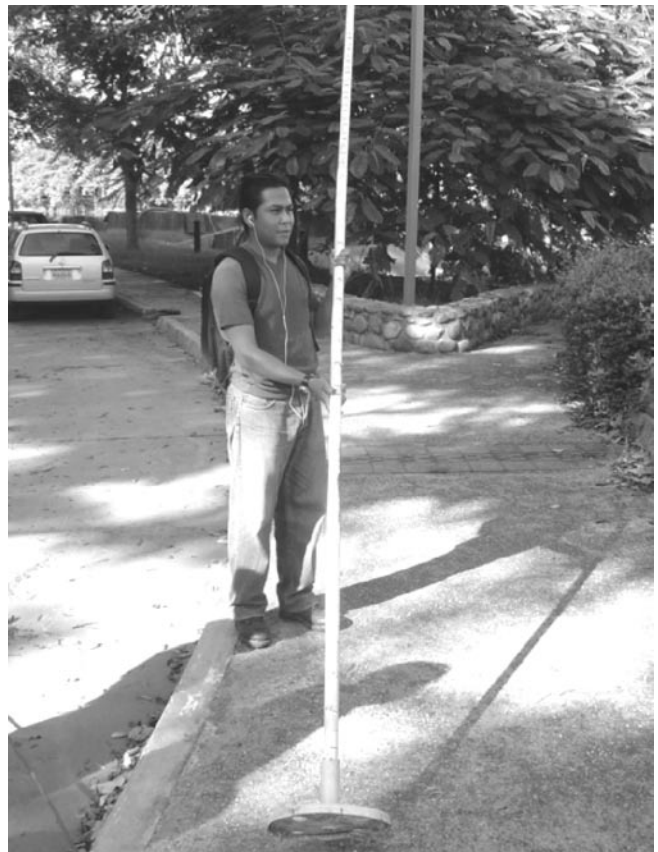
Ilustración 12. Estadal utilizado para las batimetrías.
