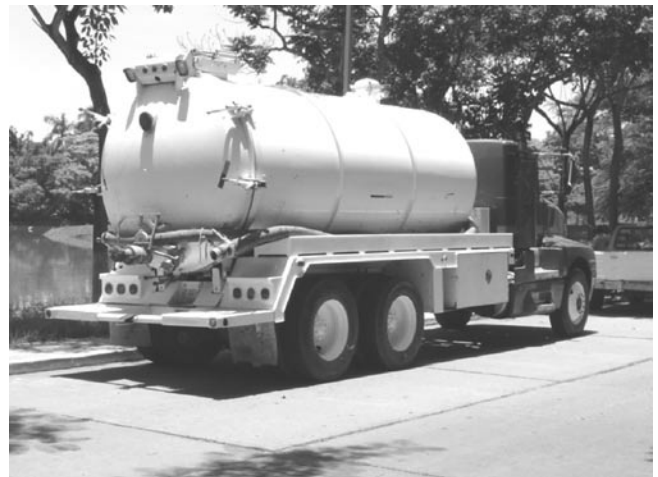
Ilustración 10. Pipa para transporte de sedimentos.
