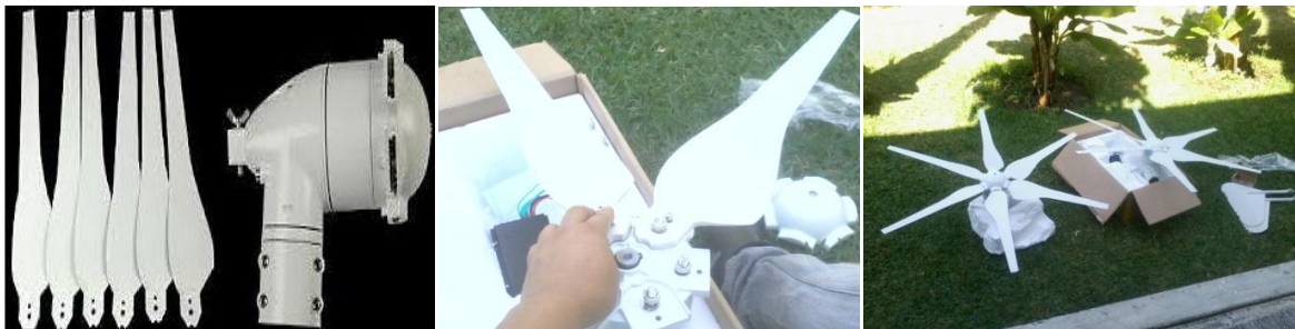
Figura 1.13 Ensamblado de Turbinas
