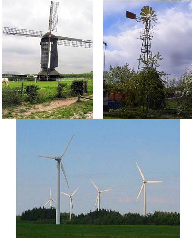
Figura 1. 2. Molino de viento, Multi-pala de bombeo para ganado y aerogenerador moderno
