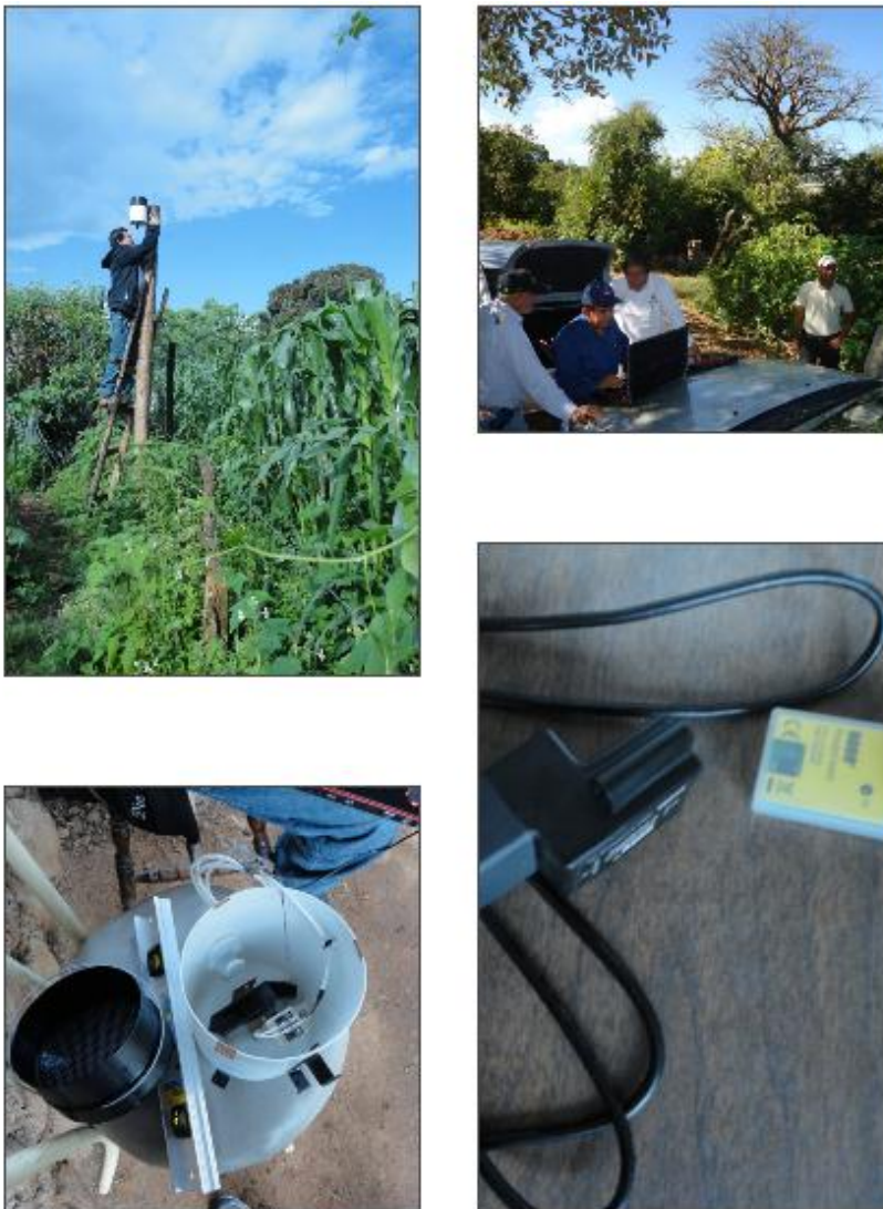
Figura 41. Actividades de secuencia para extraer la información del pluviómetro digital.
