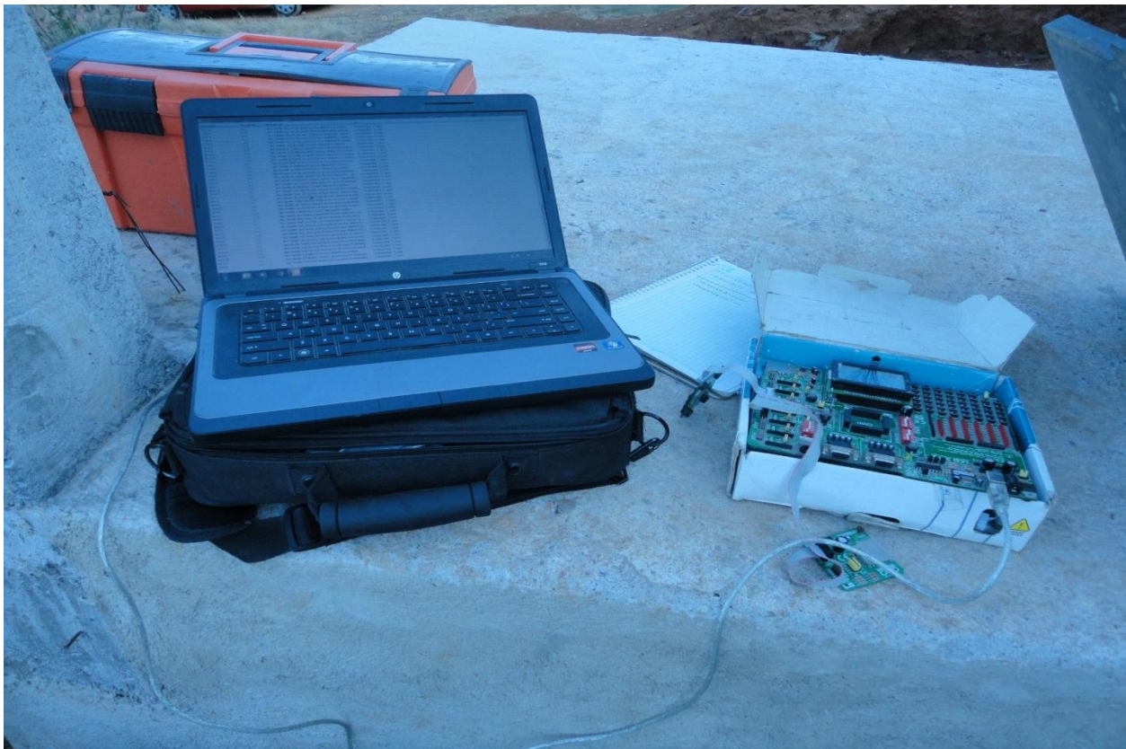
Figura 44. Obtención de información del sensor ultrasónico.
