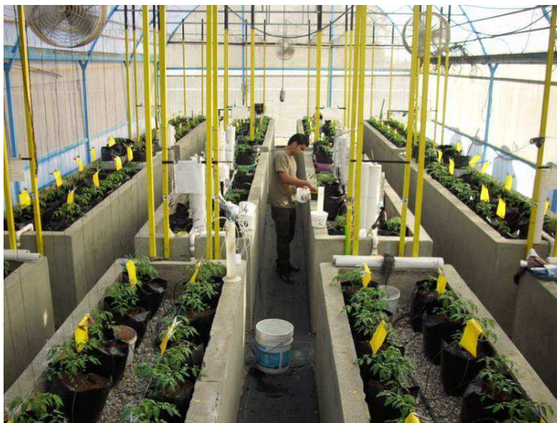
Imagen 2.9 Instalación de microlisímetros.
