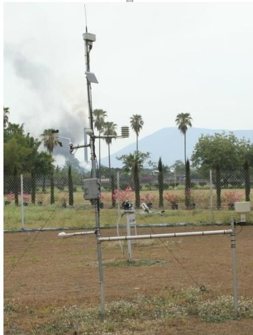
Foto 1. Instalación de sensores, recomendación de OMM.
